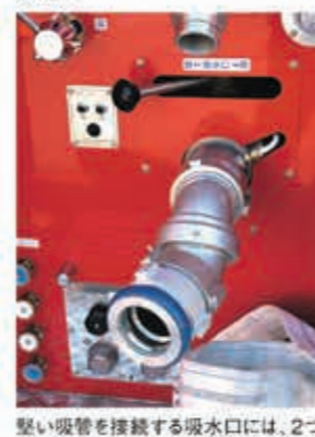
堅い吸管を接続する吸水口には、2つのスイベルを組み合わせて自在な動きが可能になるように工夫した。
