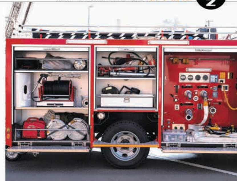
【右側面】 右側面も全体を3分割し、上部に2灯の作業灯を設置。吸管はルーフに積載することで、収納庫のスペースを確保した。中央の収納庫には筒先、ホース、エンジンカッターなどを整然と収納。最後部の収納庫には高圧ポンプ放水用フォグガン、50mの軽量高圧ホース及び巻取りリール、発電機、投光器、予備ホースなどを収納している。
