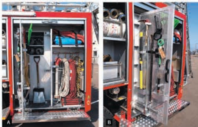
A/B スイング式収納庫を設け、細かな資機材を効率よく収納する。
