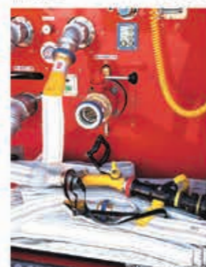
ノズルはガンタイプノズルとすることで、高圧放水や流量を抑えた放水に対応する。
