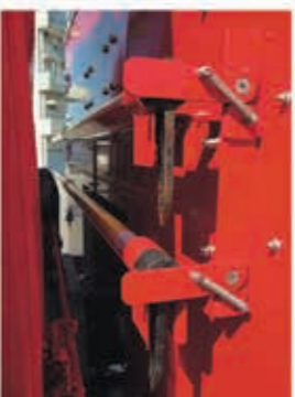
とびぐちはキャビンと収納庫の間に2本並べて取り付けた。解除機能が片側にしか付いていないので、取り出し方向は限定される。
