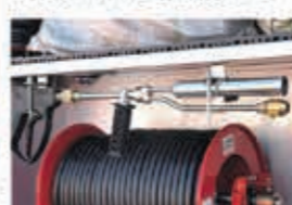
フォグガンには泡混合運転時に発泡する泡ノズルと噴霧ノズルを装着し、ワンタッチで切り替えができる。
