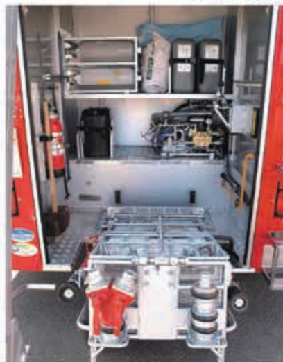
車両後部に積載するホースカーは、電動油圧式昇降装置で安全性を優先した。
