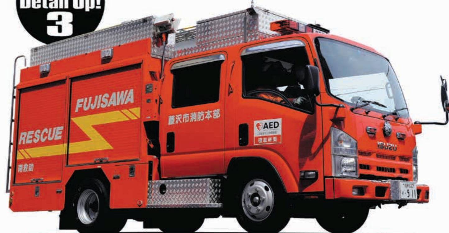
藤沢市消防本部南消防署南救助隊が運用する救助仕様のポンプ車。いすゞエルフ3t級シャーシをベースに日本ドライケミカルが改装。CD-I型に救助用資機材を多数積載した車両に仕上がった。写真・文 © 伊藤久巳
