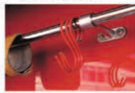
従来はキャビン内に持ち込んでいた防火衣は、吸管を移動させて出来たスペースに簡易ハンガーを取り付け、シャッター内に積載している。
