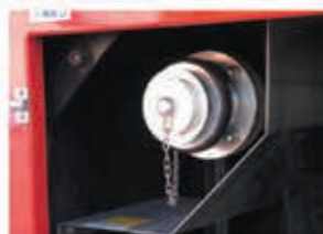
左右ホイールハウス内、後方側に水槽給口を取り付けた。
