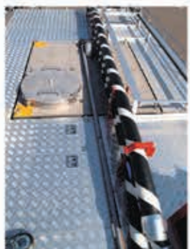
予備の吸管3本をルーフに取り付けたことで、防火衣などの収納スペースを収納庫内に作り出した。
