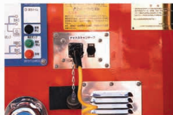
照明装置のコントローラーは、左右どちら側にも接続して使用できる。
