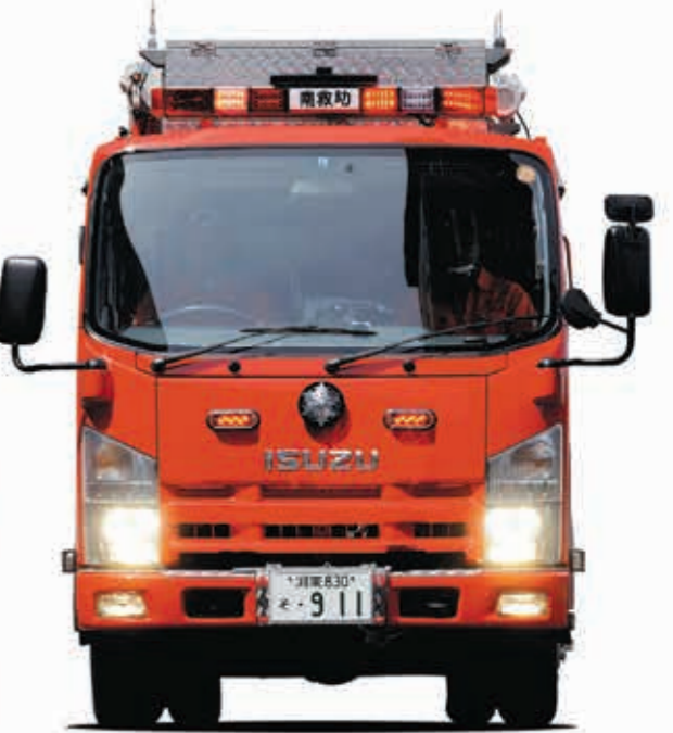
赤色警光灯はスーパーLED発光式の藤沢市仕様ものを装備。スピーカーと標識灯を内蔵する。フロントバンパーはシャーシ標準装備のものを若干前方に張り出して使用している。
