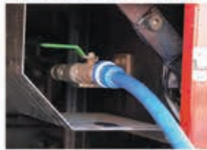
活動後に隊員が手を洗うなど便利な蛇口をホイールハウス内前方に取り付け、取り外し可能なホースを取り付けられるように工夫した。
