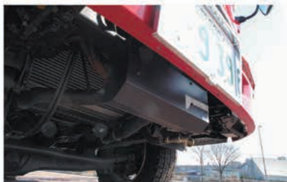
A/B スイング式収納庫を設け、細かな資機材を効率よく収納する。
