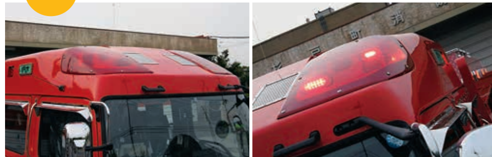
化学車は転倒角度の兼ね合いでハイルーフ化が難しい。現場隊員からの要望にこたえるべく、独自開発したハイルーフ。ビルトイン警告灯が地上からよく見えるという点をポイントに何度も修正を重ねた。
