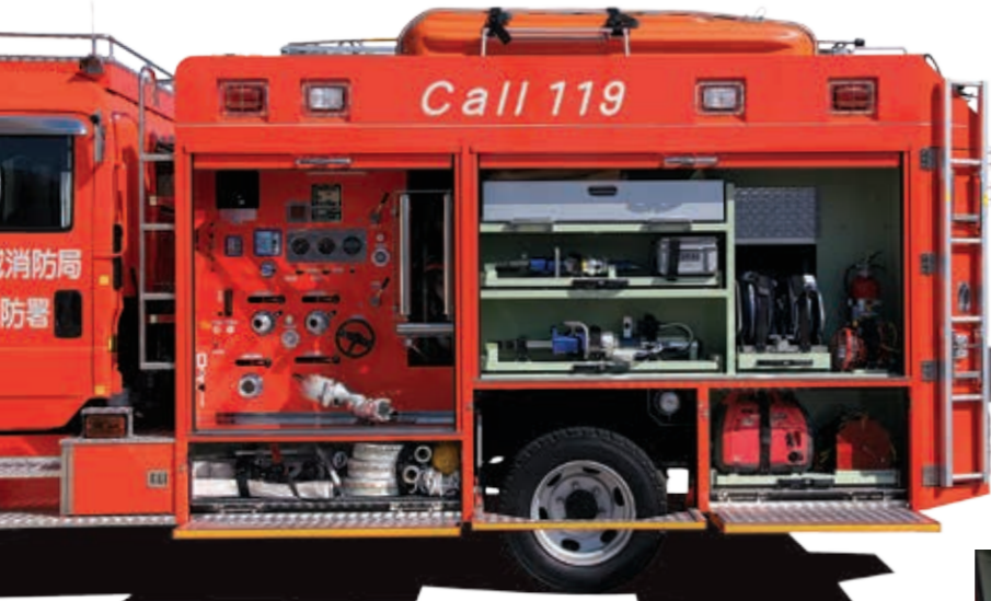
[左側面] 消火系と救助系の両立というテーマが一目で分かる左側面。ポンプ室以後は救助資機材の効率積載を目指し、緻密にレイアウトされ、ポンプ室下の即消ボックスには籐かごなども収納されている。
