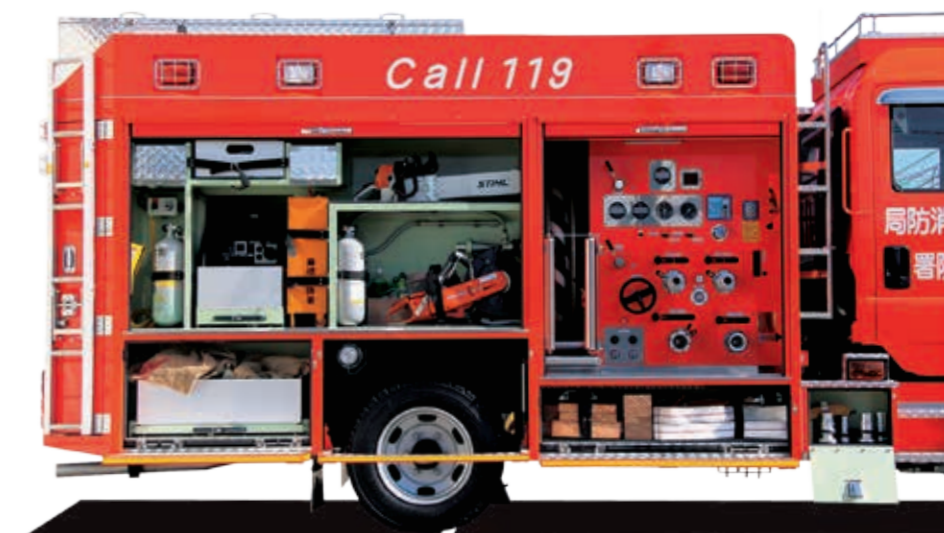
[右側面] エンジンカッターやチェーンソー、ガス溶断機といった切断系アイテムや可搬式ウィンチを収めた右側面。即消ボックスにはホースと並び、枕木を収納。このあたりも救助兼用車両ならではのといえる。
