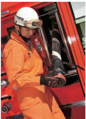
省スペースに貢献しているサイドプル方式吸管巻取り装置。吸管の設定や撤収の省力化にも繋がっている。
