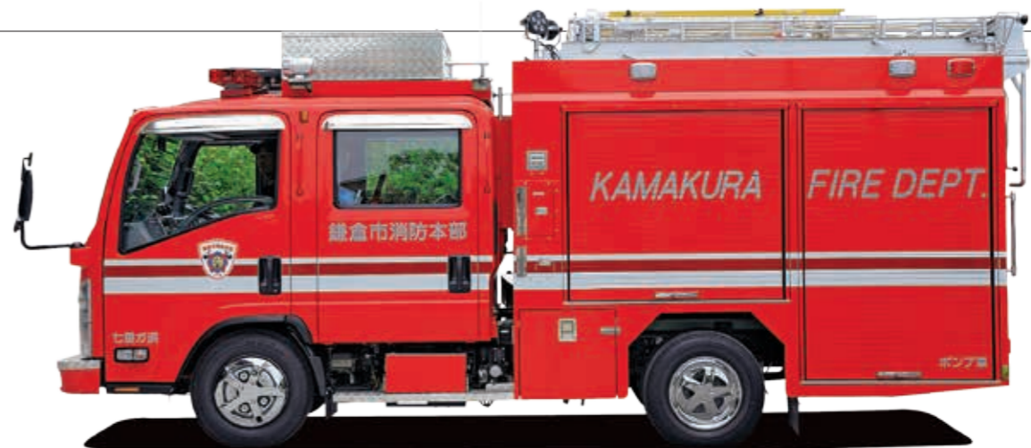
[左側面] 2.75mという短いホイールベースが際立つ。車体全長も6mに収まる。白の2本のラインが特徴で、その間は朱色のリフレクサイト。
