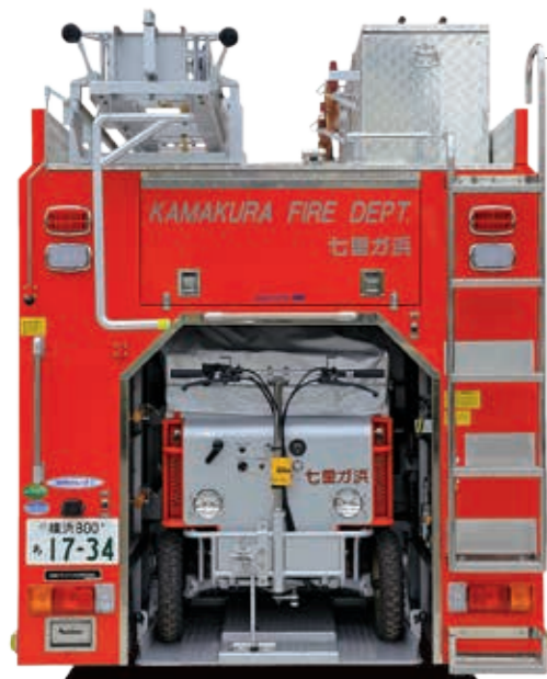
[リア] 車体後面。電動ホースカーが積載されている。右側には上部への固定式の昇降はしごが設置されている。
