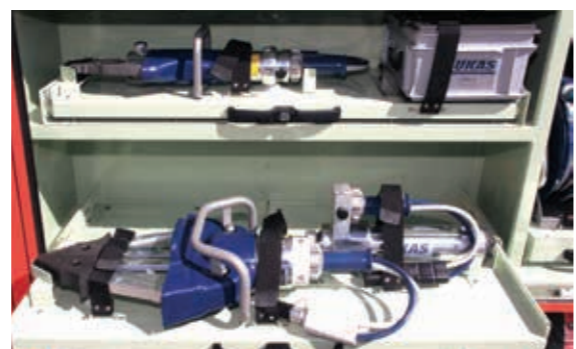
交通救助などに必要不可欠な大型油圧救助器具。ルーカス製のスプレッターとカッターを専用引き出し収納に収めている。このスペースの奥に見えるのが水槽部分。
