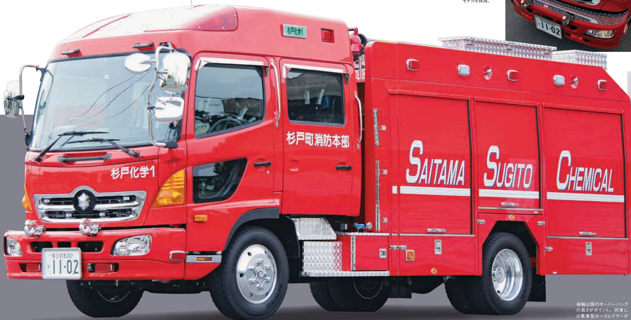
隊名標識灯には光源に有機EL照明パネルを採用。車内側の出っ張りを防ぎつつ、メンテナンスフリーで球切れの心配もない。
