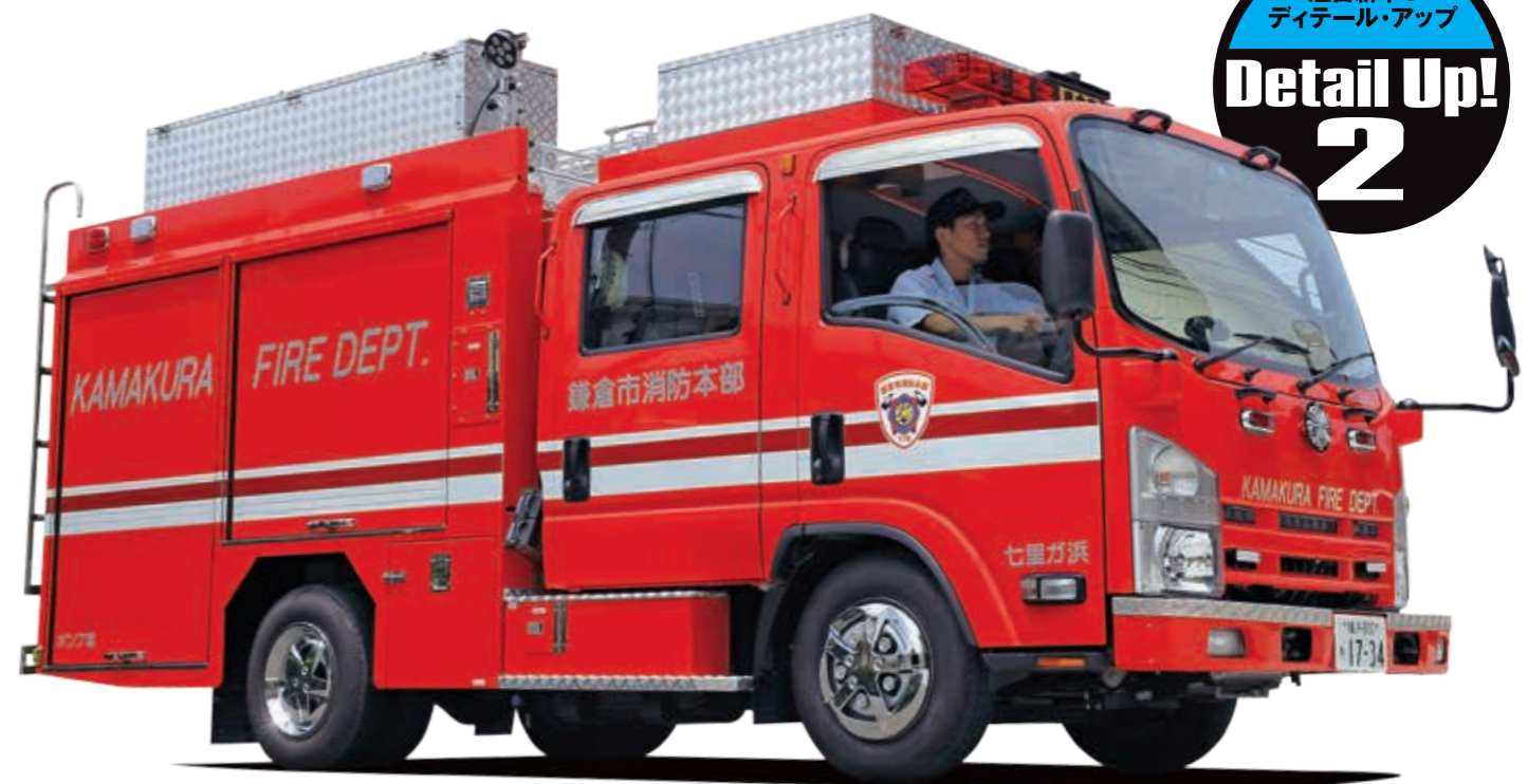
鎌倉消防署七里ガ浜出張所配備のポンプ車CD-I型。いすゞエルフ3トン級シャーシをベースとして、日本ドライケミカルが機装により製作された。
