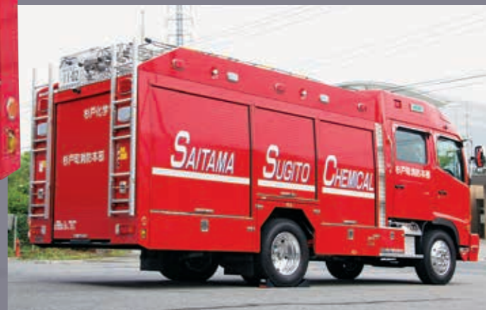
後輪以降のオーバーハングの長さがポイント。同車には乗車型ホースレイヤーが搭載されているのだ。
