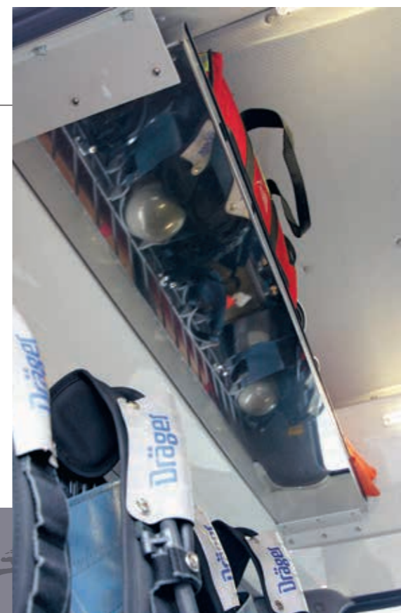
空気呼吸器積載部上の吊り棚はあえて鏡の代わりとして使用できるようにステンレス製としている。
