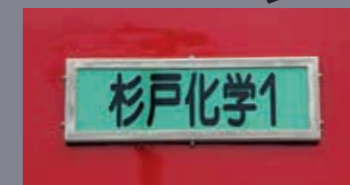
隊名標識灯には光源に有機EL照明パネルを採用。車内側の出っ張りを防ぎつつ、メンテナンスフリーで球切れの心配もない。
