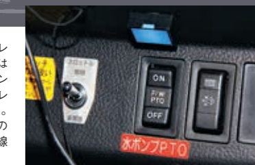
PTOスイッチはパイロットランプなどが備わっていないため、夜間は場所が分かりにくい。そこで照明を備え、容易に位置を確認できるようにしている。
