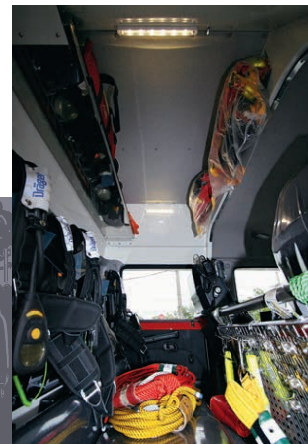
ハイルーフ化により最大1750mmの高さを確保した車内。
