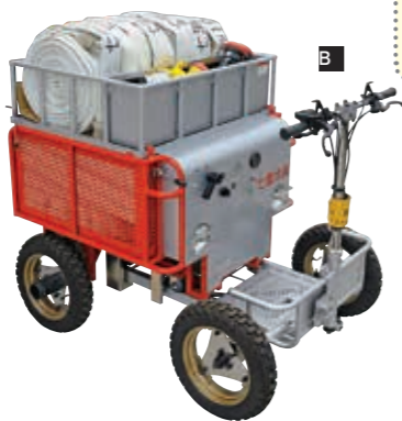
[リア] 車体後面。電動ホースカーが積載されている。右側には上部への固定式の昇降はしごが設置されている。
