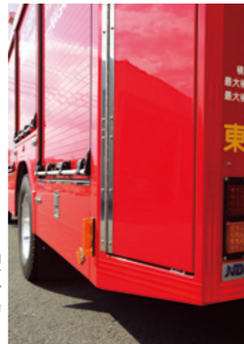
車体後面の制動灯、合図灯、後退灯はすべてLED式。
