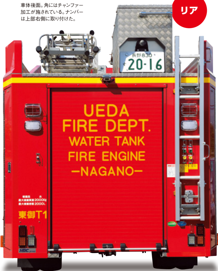
車体後面の制動灯、合図灯、後退灯はすべてLED式。
