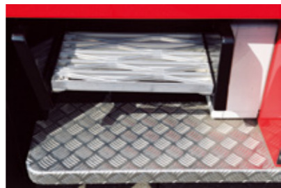
ダブルキャブ後席のステップ上段は冬期の降雪に備えて網状になっている。
