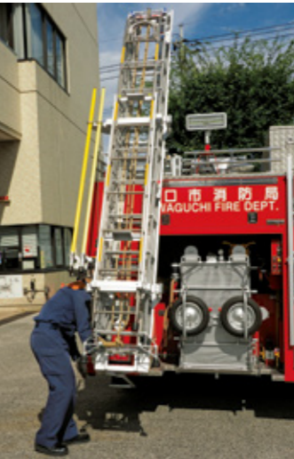
三連はしごは下段2段目までと上段4段目までの強度を高めた川口消防仕様。
