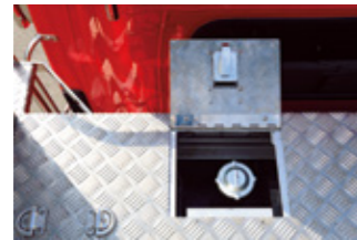
資機材収納庫の最前部に設置された燃料タンクの給油口。給油口が車上スペースにあることにより、携行缶の給油が楽になった。
