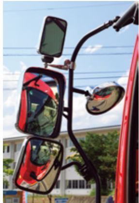
左サイドミラーには、隊長席用のミラーを最上段に増設した。
