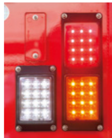
車体後面の制動灯、合図灯、後退灯はすべてLED式。
