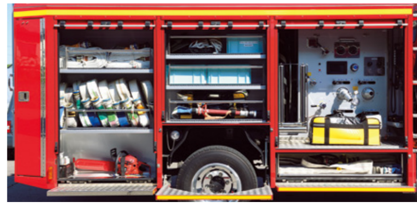
ポンプ操作盤後端にはサイドプル方式の吸管巻き取り装置。ポンプ操作盤の後方(写真左側)は資機材収納庫となる。中央、後方の資機材収納庫にはホース、筒先、金具などのほか、後方下段にチェーンソーが積載される。また、最後部のチャンファー加工された角部には長尺資機材も収容可能な資機材収納庫がある。
