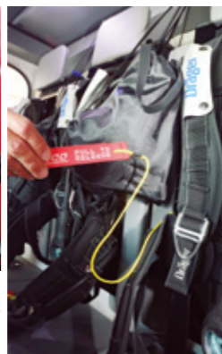
後席には4名分の空気呼吸器と面体が収納され、着用時には肩ベルトを通してひもを引くと呼吸器本体が外れる固定装置(ウォーカーウェイ)を採用。なお、後席からも拡声できるマイクとサイレンスイッチが前席の後部に設置されている。
