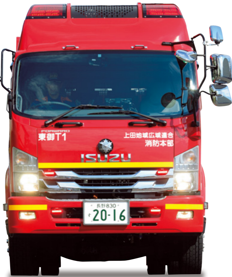
左サイドミラーには、隊長席用のミラーを最上段に増設した。
