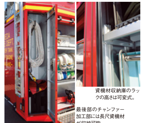
ポンプ操作盤後端にはサイドプル方式の吸管巻き取り装置。ポンプ操作盤の後方(写真左側)は資機材収納庫となる。中央、後方の資機材収納庫にはホース、筒先、金具などのほか、後方下段にチェーンソーが積載される。また、最後部のチャンファー加工された角部には長尺資機材も収容可能な資機材収納庫がある。
