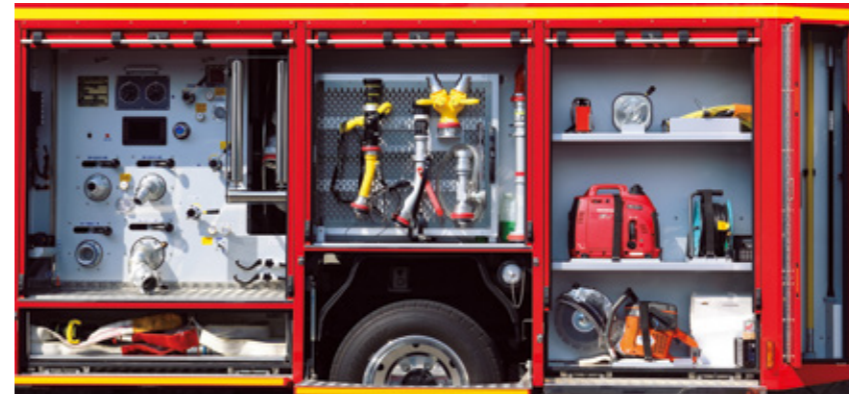
右側側面と同様、車体左側側面の前部シャッター内はポンプ操作盤、中央と後部シャッター内は資機材収納庫となる。資機材収納庫の中央シャッター内は展開式。後部シャッター内にはエンジンカッター、軽量可搬式投光器などが収納されている。
