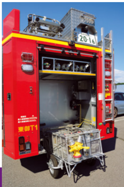
後面シャッター内には中央に電動昇降装置に載った手動式ホースカー、その上段には空気ポンプが収納されている。ホースカーは長距離のホース延長が必要な事案に活用されている。
