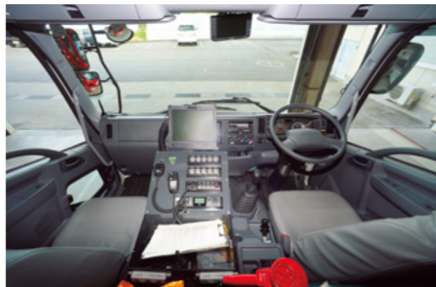
センターコンソールには10連スイッチと無線装置、AVMモニターを設置。ミッションはマニュアルで、前進6段。
