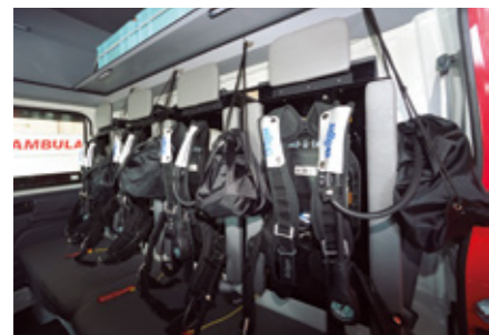
後席には4名分の空気呼吸器と面体が収納され、着用時には肩ベルトを通してひもを引くと呼吸器本体が外れる固定装置(ウォーカーウェイ)を採用。なお、後席からも拡声できるマイクとサイレンスイッチが前席の後部に設置されている。
