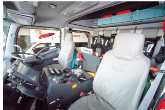
ハイルーフのデッドスペースには資機材収納庫を作りこんでいる。暑さ対策のため、後席にもエアコンの吹き出し口を設置した。
