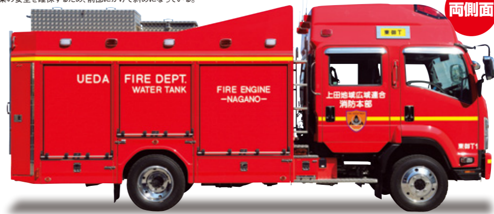
車体右側側面正横。駆動方式は4×4。ポンプ室上部のあおりは、ルーフ上での作業の安全を確保するため、前部にかけて斜めになっている。
