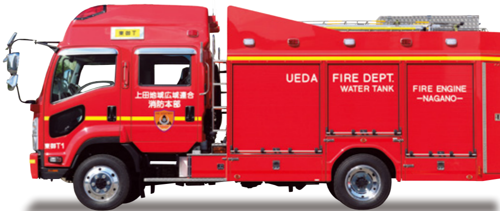
車体左側側面正横。あおり部の3灯の周囲照明灯のスイッチはキャブとポンプ室の両方にあり、シーソースイッチの採用により両所で自由に入切の操作が可能。
