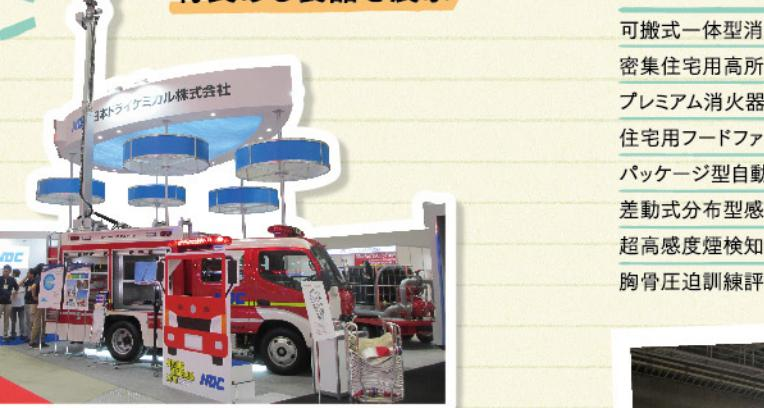
先端にカメラを搭載した昇降ポールにより、地上8mの高さから確実な放水が可能。密集市街地など狭い路地での消防活動に威力を発揮する消防車「DRFFE」。
