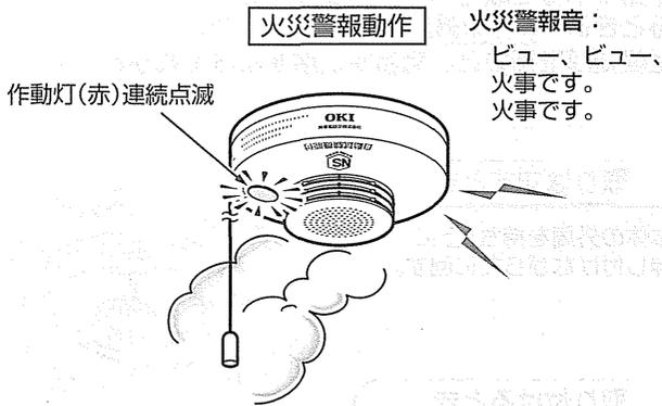
煙検知部の煙がなくなれば、火災警報動作が止まり通常の状態に戻ります。
