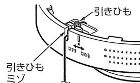
注 引きひもが引きひもミゾに正しく収まっていない状態で本体を取付ベースに取り付けると、引きひもを正しく操作できなくなったり、本体を取付ベースから取りはずすことができなくなります。
