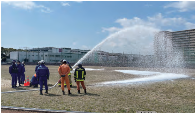
FireDos混合システムによる泡放射
