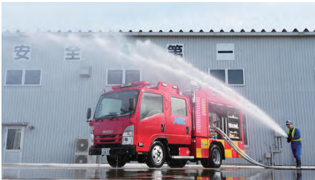
消防者付属のポンププロポーション方式での放射イメージ
