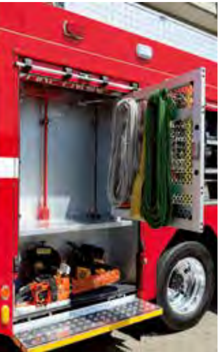
右側後部は展開式収納扉とし、ロープ類や地下式消火栓器具等を収納。チェーンソーやエンジンカッターは鉄のドアや土蔵の扉等を破壊するのに便利。
