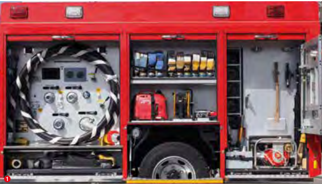
左側面 ①吸管を格納するポンプ室とその下部に収納スペース、中央に予備ホース、発電機と電源コードリール、後部に予備呼吸器収納庫とスイング式の収納スペース、ファイヤードスも個々に格納している。②スイング式の収納扉の構造にもひと工夫。マチを作ることで、後部パネルとの接触を回避している。③悩みに悩んだファイアドスの収納スペース。取り出しも容易で、しっかりと固定されている。
