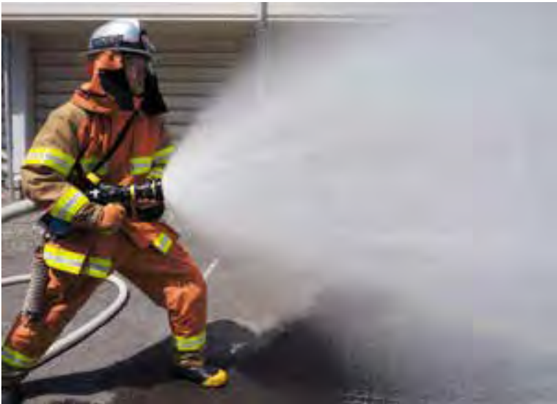
広い範囲に散布できるので、残火処理などに有効に活用できる。
