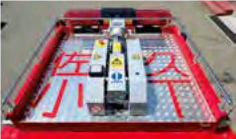
キャブ上の作業台には日本初導入となるテクライトを設置。コンパクトなではしごの車上伸梯の際の邪魔にもならない。左上には緊急停止ボタンも備える。
