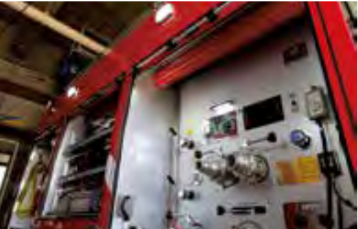
スモールランプを点灯すると、シャッター内の照明はすべて自動で点灯する。これも省力化のための工夫だ。
