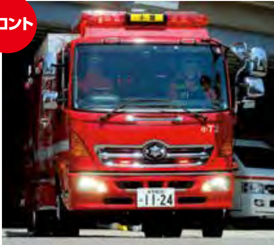
キャブはハイルーフ化せず、鎧鍔作業台のみ設置。LEDは日照角度によっても見えにくいので、ハイブリッドタイプの警光灯を採用した。
