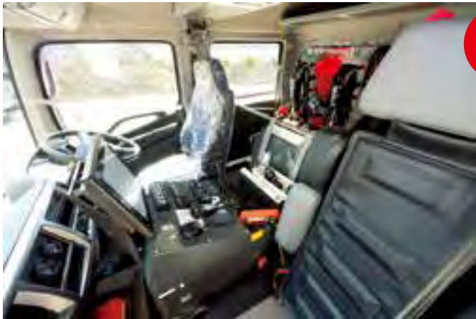
（上）隊長席の空気呼吸器埋め込み型シートは国産のレスキューシートを採用。座面はノーマルシートを流用しているため位置が低く、前方が見渡しやすい。／（右）後部座席の背もたれは前倒し式を採用。収納スペースにはヘリとの連携用資機材を収納。
