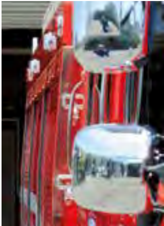
シャッター部を曲面加工しているため機関員がミラー越しに後部まですっきりと見通せる。
