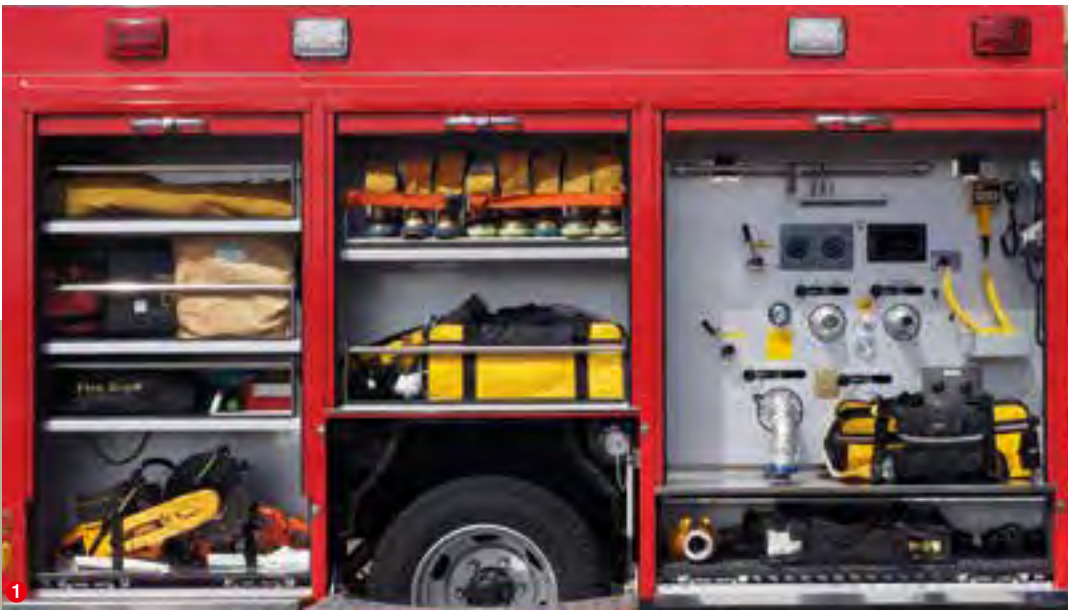
右側面 ①ポンプ部のレイアウトと中央部分は左側面同様、後部は熱画像直視装置やウインドソックス、エンジンカッターなどの資機材を収納する。②使用後に汚れた防火衣などを掛けられる工夫を上部に施した。③オールシャッター化により生まれたスペースを有効活用し、ホースバッグをポンプ部にも配置している。④中央のスペースにはガンタイプノズル2基とホースバッグを収納。
