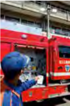
ライトの操作は右側面に設置した専用コントローラーで行う。上下ボールの伸縮は空圧シリンダーを採用している。
