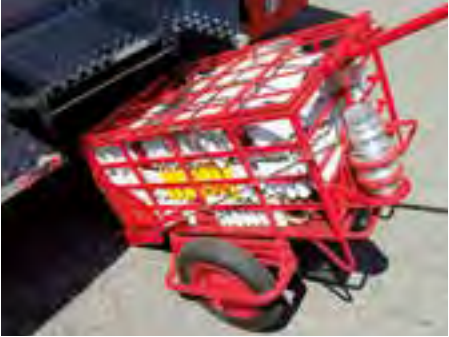
特注の薄型ホースカー。65mmホースを7本搭載する。
