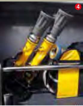
右側面 ①ポンプ部のレイアウトと中央部分は左側面同様、後部は熱画像直視装置やウインドソックス、エンジンカッターなどの資機材を収納する。②使用後に汚れた防火衣などを掛けられる工夫を上部に施した。③オールシャッター化により生まれたスペースを有効活用し、ホースバッグをポンプ部にも配置している。④中央のスペースにはガンタイプノズル2基とホースバッグを収納。
