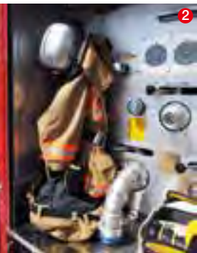
左側面 ①吸管を格納するポンプ室とその下部に収納スペース、中央に予備ホース、発電機と電源コードリール、後部に予備呼吸器収納庫とスイング式の収納スペース、ファイヤードスも個々に格納している。②スイング式の収納扉の構造にもひと工夫。マチを作ることで、後部パネルとの接触を回避している。③悩みに悩んだファイアドスの収納スペース。取り出しも容易で、しっかりと固定されている。
