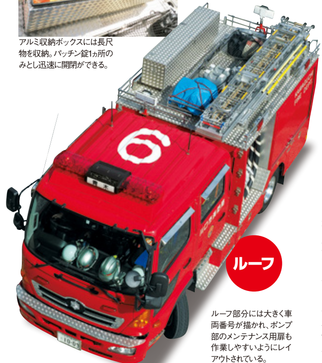
軽量化のため、はしご昇降装置は手動式を採用。キャブ内のモニタで収納状況を確認できる。他の川口消防仕様ポンプ車と同じく、単はしごを展開すれば、三連はしごがすぐ外せるようにしている。
