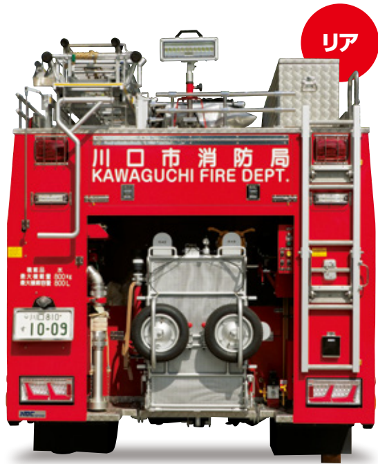
後部のみカメラを装備。死角となる後方の安全確認をキャブ内ですることができる。迅速な活動開始のためシャッターは設けていない。
