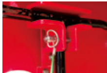
ホースカー裏の資機材の格納には、より確実性が高いピンロックを使用している。
