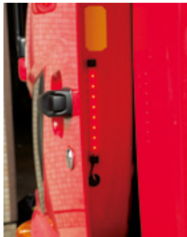
ドアを開けると側部の赤いLED灯が点灯し、夜間の安全確保につながっている。
