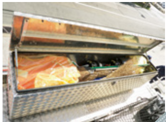
アルミ収納ボックスには長尺物を収納。パツチン錠1か所のみとし迅速に開閉ができる。
