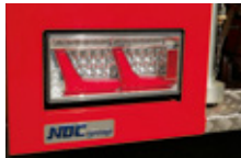
機装メーカーのプレートは従来の「日本ドライケミカル」から「NDC group」に変更。ICチップが埋め込まれており、専用端末で読み込むと整備状況がわかる。
