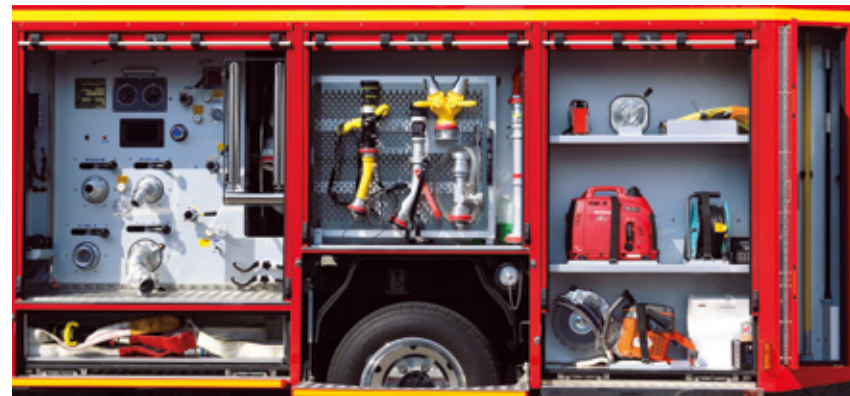
ポンプ操作盤後端にはサイドプル方式の吸管巻き取り装置。ポンプ操作盤の後方(写真左側)は資機材収納庫となる。中央、後方の資機材収納庫にはホース、筒先、金具などのほか、後方下段にチェーンソーが積載される。また、最後部のチャンファー加工された角部には長尺資機材も収容可能な資機材収納庫がある。
