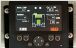
キャブ前方にあるワーニングモニタで、各扉の開閉、はしご昇降装置、ホースカー昇降装置のロック状況などが一目で分かる。
