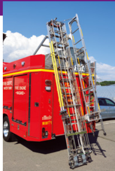
資機材収納庫の屋根上の高さの関係から、三連はしご/単はしごは自動昇降装置付き。
