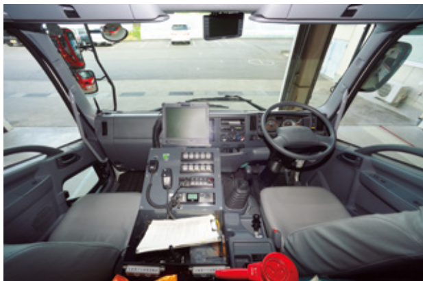
センターコンソールには10連スイッチと無線装置、AVMモニタを設置。ミッションはマニュアルで、前進6段。
