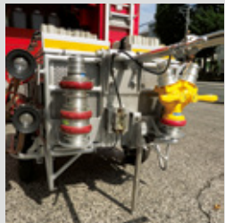
ホースカーは地面と平行に自立できるように、簡易スタンドを取り付けている。
