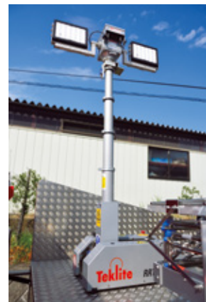
LED式投光器「テクライト」。容量150W×2灯。有線・無線リモコンで灯体の左右旋回、角度切り替えが可能。
