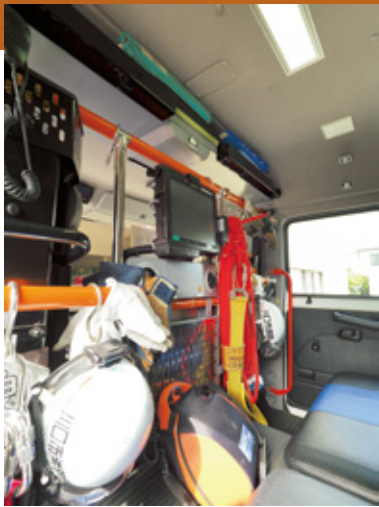
前席上方にはバンチング板を使用した収納庫を設置。隊長席にポストロムシートを採用。
