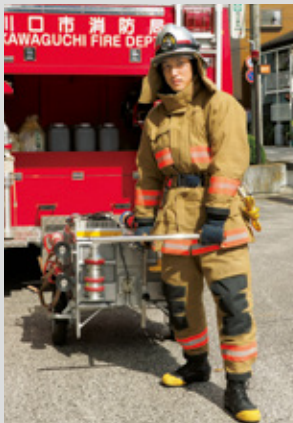
加納式ホースカーは、従来からの川口消防仕様。機装メーカーと入念な打ち合わせを行い、簡易スタンドやホースを積載できる枠をオーダーした。
