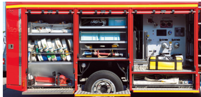
ポンプ操作盤後端にはサイドプル方式の吸管巻き取り装置。ポンプ操作盤の後方(写真左側)は資機材収納庫となる。中央、後方の資機材収納庫にはホース、筒先、金具などのほか、後方下段にチェーンソーが積載される。また、最後部のチャンファー加工された角部には長尺資機材も収容可能な資機材収納庫がある。
