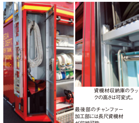
ポンプ操作盤後端にはサイドプル方式の吸管巻き取り装置。ポンプ操作盤の後方(写真左側)は資機材収納庫となる。中央、後方の資機材収納庫にはホース、筒先、金具などのほか、後方下段にチェーンソーが積載される。また、最後部のチャンファー加工された角部には長尺資機材も収容可能な資機材収納庫がある。
