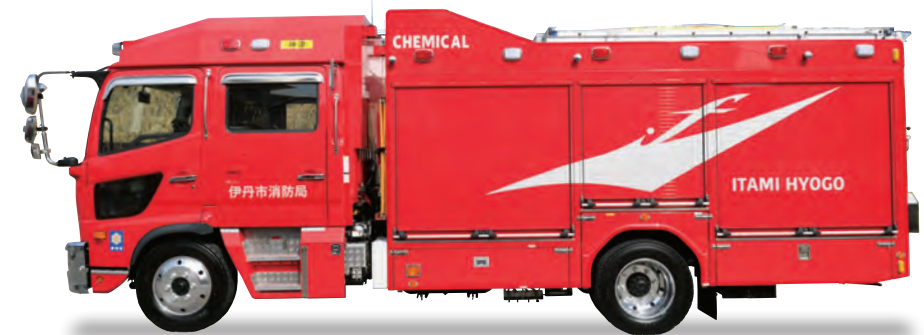
車体左側側面。クラスA、クラスB薬剤の両方を積載し、A火災、B火災に瞬時に対応可能。ダブルキャブにはハイルーフを採用する。
