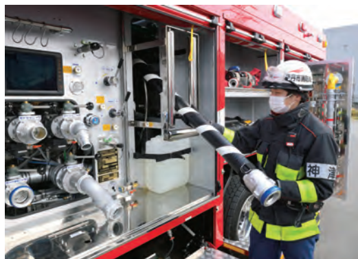
サイドプル方式の吸管をガイドのローラーを通過させて取り出す。
