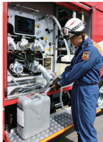
ポンプブロポーション方式によるクラスB泡消火薬剤混合。ポリ容器などに入ったB薬液をB泡用外部吸液口から吸い上げることでも混合可能となっている。
