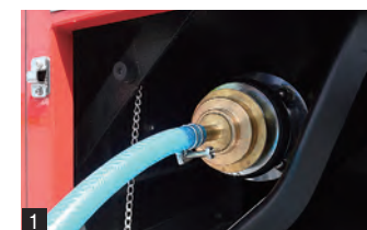
1 2 タイヤハウス内には水槽への送水口があり、蛇口も取り付け可能。
