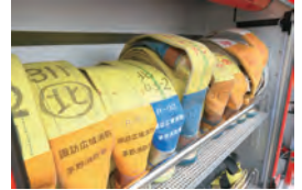
▲資機材収納庫の奥行きが確保されたことにより、側面から見て65mmホースを縦に収納可能な構造になっている。
