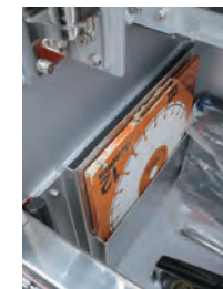
▲車体左側後部資機材収納庫の下部に設けられた、積載するエンジンカッターの刃を収納するラック。
