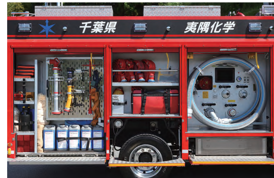
ポンプ操作盤の後方は資機材収納庫で、後部下段には外部吸液用のA薬液タンクを積載する。
