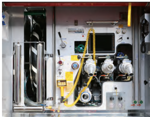
車体右側のポンプ操作盤。上段に放水口が3口、下段に中継口が1口。AB泡消火薬剤はそれぞれ自動圧送比例方式、ポンプブロポーション方式での混合が可能。黄色いコードは照明装置の有線リモコン。
