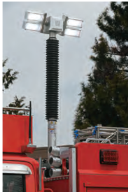
ナイトスキャンチーフEVOLUTION II型照明装置。LED式で、容量は90W×4灯。
