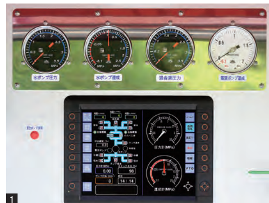
1 2 3 4 アナログ式の圧力計、連成計（それぞれ水ポンプと混合液圧力）の下には12インチのカラー液晶モニターによる自動揚水システムおよび自動混合操作パネル。アンサーバック方式で操作は容易。右側には圧力計と連成計がアナログ風デジタル表示され、とくに冬季には有効。最上段は基本画面で、圧力、流量、コックの開閉などが一目でわかるよう表示される。上から2枚目は混合モード（画面では混合比設定3.0%）、3枚目はエラー履歴、最下段はヒューズモニター。
