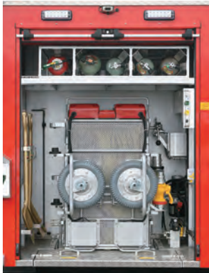
車体後部には電動ホースカーを積載する。上部は空気ポンプ（8Lポンプも収納可能）と消火器を収納するラックとなる。
