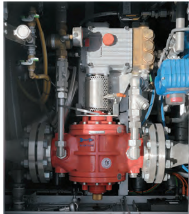
屋上の点検ふたから見たファイア・ドス1600混合装置。
