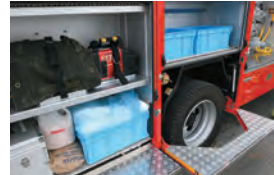
▲市販の軽量なカラーボックスを各所に積載可能で、資機材の積み替えが容易。
