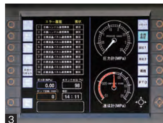
1 2 3 4 アナログ式の圧力計、連成計（それぞれ水ポンプと混合液圧力）の下には12インチのカラー液晶モニターによる自動揚水システムおよび自動混合操作パネル。アンサーバック方式で操作は容易。右側には圧力計と連成計がアナログ風デジタル表示され、とくに冬季には有効。最上段は基本画面で、圧力、流量、コックの開閉などが一目でわかるよう表示される。上から2枚目は混合モード（画面では混合比設定3.0%）、3枚目はエラー履歴、最下段はヒューズモニター。
