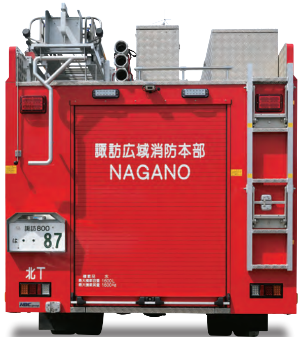
車体後面。ホースカーラックなどの凍結を防止するため後面もシャッター式を採用する。周囲照明灯は通常押しで左右後面それぞれがオン/オフ、長押しで3方向すべてがオン/オフする。
