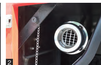
1 2 タイヤハウス内には水槽への送水口があり、蛇口も取り付け可能。
