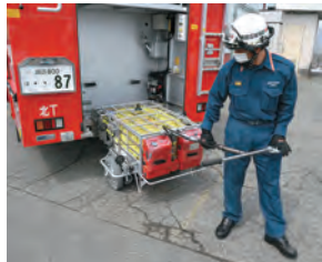
電動ホースカーの収納ラックは電動式。
