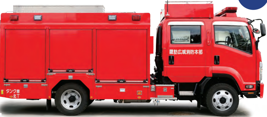
▼車体右側面。北部分署車両の高さの関係から全高を2950mmに抑えたほか、山間の勾配路対策としてリアのオーバーハングも短縮している。
