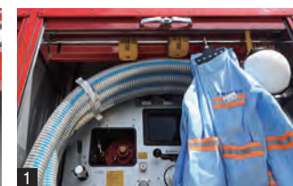
1 2 3 ポンプ操作盤の上部には取り外し可能な資機材収納用のバーがあり、出動の際に保安帽や感染防止衣などを引っ掛けての収納が可能。
