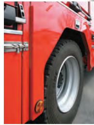
▲リヤフェンダーは外側へ厚みを付けることで、タンク水満載時のロールによりタイヤが車体に干渉しないよう工夫。
