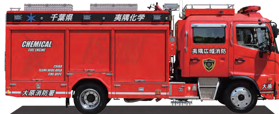
ダブルキャブの後方にはポンプ装置とファイア・ドスFD1600、500L薬液槽、1300L水槽と続く。FD1600は毎分最大1600Lの泡放射が可能。緊急消防援助隊登録車両。
