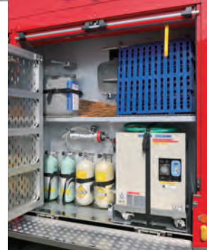
後方の資機材収納庫を展開すると、クラスA泡消火薬剤、空気ボンベなどが収納されている。最後部の下段は除染用オゾン水生成器。
