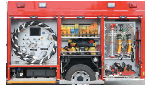
▲車体左側のポンプ操作室と資機材収納庫のシャッターを開放。こちら側のポンプ操作盤には吸管を備える。資機材収納庫部分の奥行き拡幅により、ポンプ操作室も同様に奥行きが大きくなり、吸管約3巻分が余裕で収納される。
