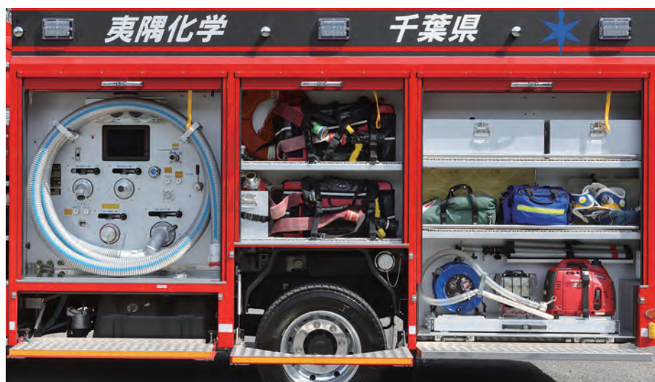
左側面のシャッターをすべて開放する。後部資機材収納庫の下段は引き出し式で、投光器と発電機が収納されている。外部吸液口に接続するホースもここに収納される。
