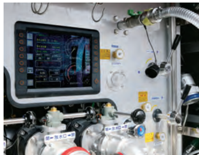
ポンプブロポーション方式によるクラスB泡消火薬剤混合。ポリ容器などに入ったB薬液をB泡用外部吸液口から吸い上げることでも混合可能となっている。
