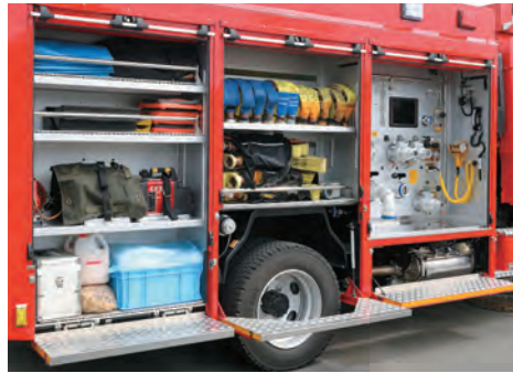
▲車体右側の資機材収納庫とポンプ操作室のシャッターを開放。車体幅を少し拡幅することにより、資機材収納庫の奥行きを確保した。また、カラーボックス内は薬液容器を4本積載可能となり、泡放射の際にはこちらから使用する。
