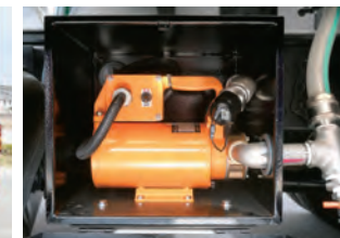
車両左側の燃料タンク横に設置された電動ポンプを使ってポリ容器などの薬液を車両薬液タンクに送液することが可能となっている。
