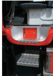
▶車体左側の後部資機材収納庫は展開式のパンチングプレートを用意。収納庫上部には、後面から出し入れする空気ポンプと消火器のラック上に、長尺資機材を収納することが可能。
