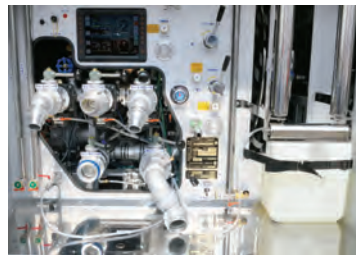
薬液タンク内の薬液は車両左側ポンプ室に設けた給液口から車両外部へ吐出可能。放水口に接続するラインプロポーションの吸液ホースを接続することで水ポンプ内を薬液で汚すことなくB泡の放射が可能となる。
