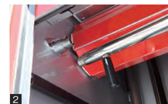
1 2 3 ポンプ操作盤の上部には取り外し可能な資機材収納用のバーがあり、出動の際に保安帽や感染防止衣などを引っ掛けての収納が可能。
