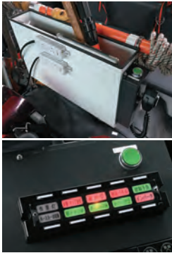
前席、後席仕切りの中央には金属製の収納ボックスがあり、そこには100V電源の可動式コンセントを磁石で設置。外部接続時に使用するコンセントと車両起動時にインバーターのスイッチを投入して使用するコンセントの二つがある。
