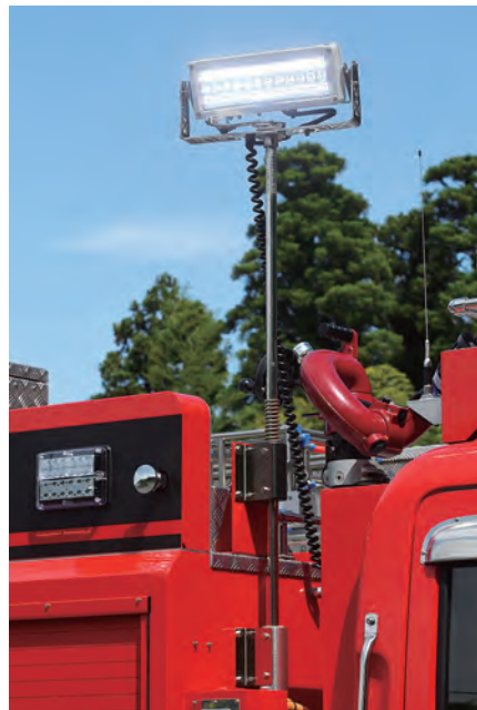
ポンプ室の前盤には手動昇降式のLED照明装置。容量は280W。
