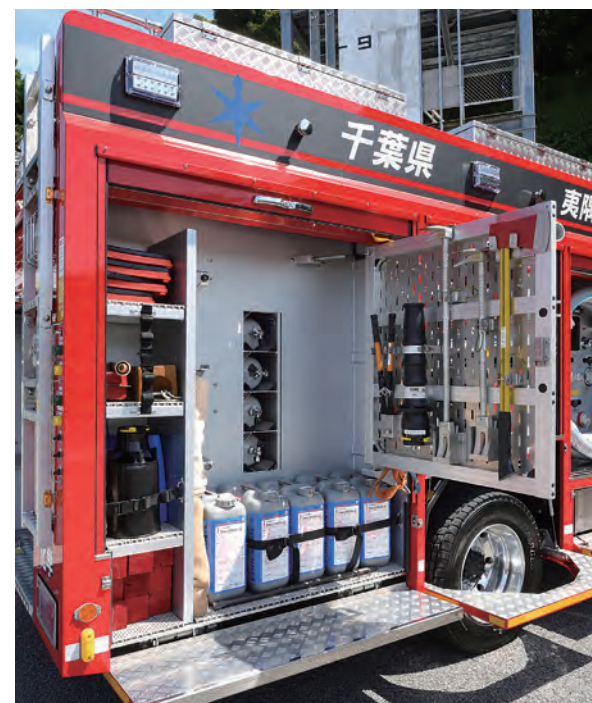
右側面後方上部は展開式ラックを備える。開放すると中央には後方のホースカー格納スペースのデッドスペースを利用した空気ボンベ収納ラックがある。
