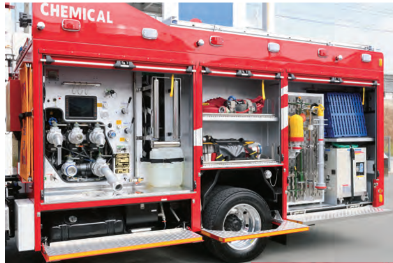
車体左側のシャッターを開放する。後方の資機材収納庫は展開式で、スタンドパイプや照明用三脚など比較的長尺の資機材がバンチングボードに収納されている。なお、ポンプ操作盤/資機材収納庫ボックス外板のキャブ寄りには水利の折りたたみ式警戒柵を収納。
