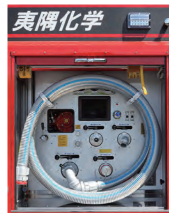
ポンプ操作盤。上段には2口の放水口、下段には吸水口と中継吸口。上部の液晶モニターの左側にはファイア・ドスの点検口が開く。
