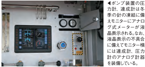
▲12インチの大型液晶モニターは操作する機関員が迷うことのないアンサーバック方式。泡消火薬剤の混合比の設定などが可能なほか、空運転を最小限にするためPTOの操作も可能。写真右は水ポンプと混合装置の水と混合液の流れが一目でわかる画面、左は混合比設定を3%にした画面。
