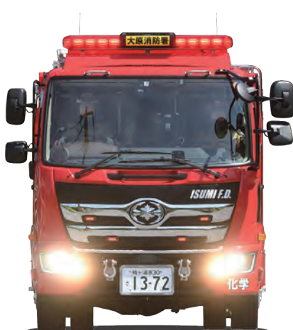
フロントグリルの下、バンパー上にはわずかに縞鋼板がのぞく。左右2個のシャックルはそれぞれ最大荷重2t。
