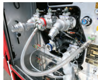
薬液タンク内の薬液は車両左側ポンプ室に設けた給液口から車両外部へ吐出可能。放水口に接続するラインプロポーションの吸液ホースを接続することで水ポンプ内を薬液で汚すことなくB泡の放射が可能となる。
