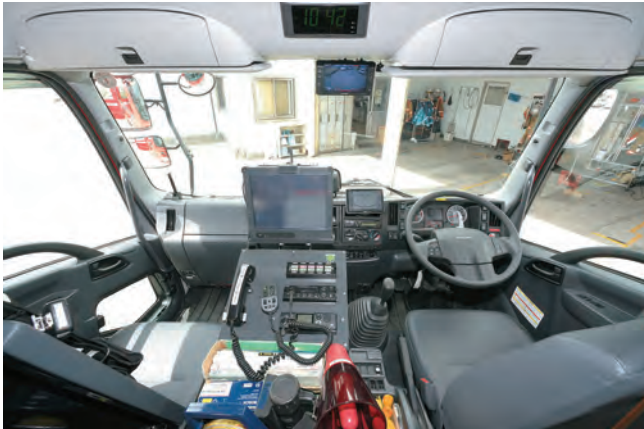
ダブルキャブは定員6名。ミッションは6速マニュアルを採用。隊長席は背面に空気呼吸器を収納する。
