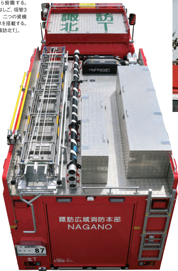
ナイトスキャンチーフEVOLUTION II型照明装置。LED式で、容量は90W×4灯。
