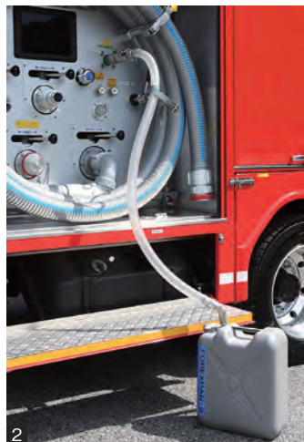
1 2 左側のポンプ操作盤には外部吸液口が設けられ、ホースを接続して薬液ポリタンクからファイア・ドスシステムへと吸液される。通常は車体の薬液槽にB剤を積載するため、A剤の入った薬液ポリタンクを積載する。
