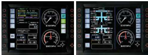
▲12インチの大型液晶モニターは操作する機関員が迷うことのないアンサーバック方式。泡消火薬剤の混合比の設定などが可能なほか、空運転を最小限にするためPTOの操作も可能。写真右は水ポンプと混合装置の水と混合液の流れが一目でわかる画面、左は混合比設定を3%にした画面。
