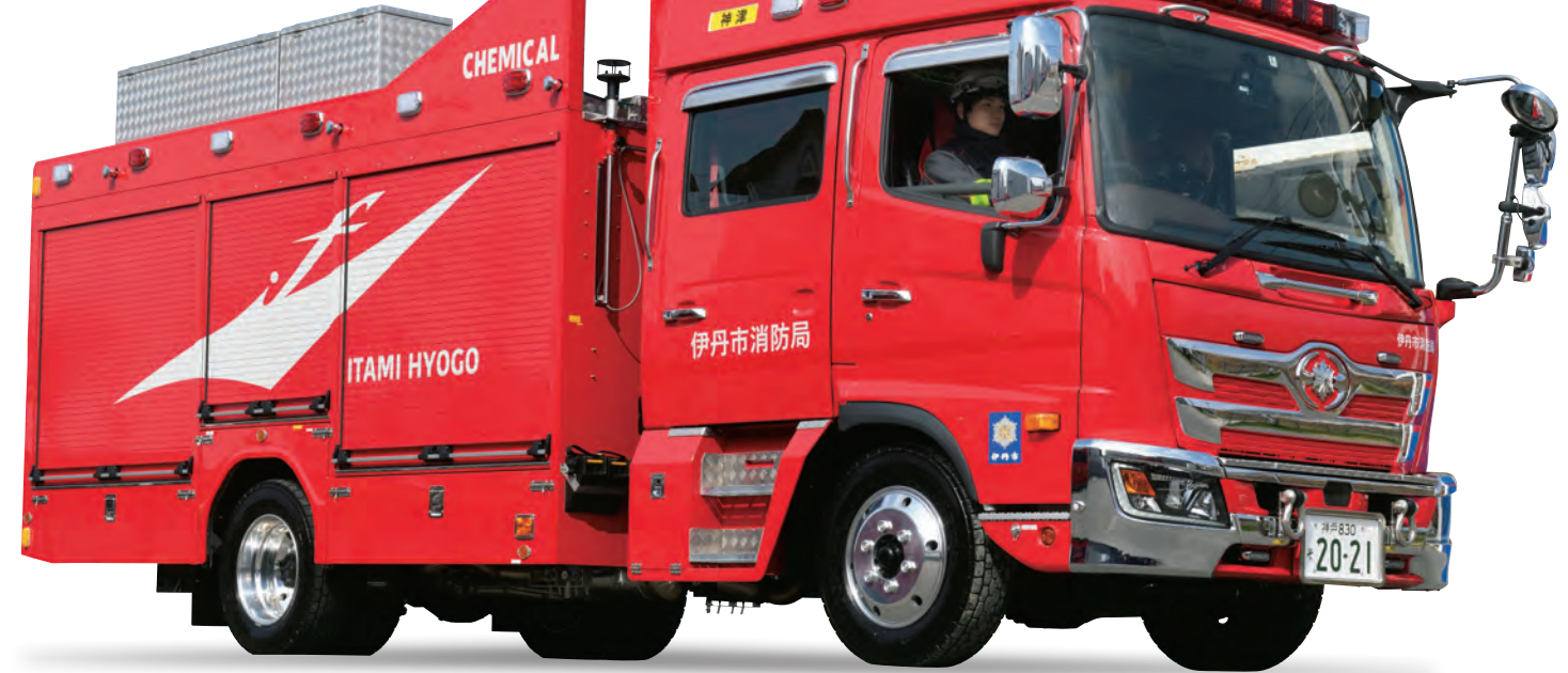
伊丹市消防局東消防署神津出張所に配備された化学車II型(神津4)。日野レンジャー5.5t級シャーシをベースに、日本ドライケミカルが艦装を担当した。令和3年3月16日配備。
