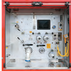
▲車体右側のポンプ操作盤。12インチの大型液晶モニターが特徴。左上段に外部吸液口、上段に放水口が2口、下段に吸水口と中継吸口、右最下段に混合液吐出口。
