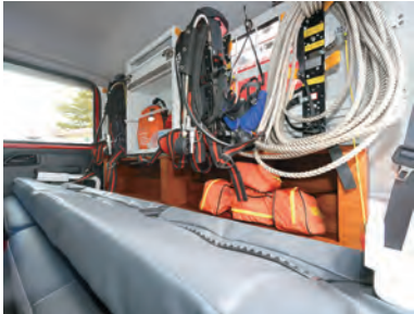
後席は通常最大でも2名乗車のため、中央右席の空気呼吸器のラックをつぶし、AEDなどの資機材収納ボックスを設置。座面下、シートバック後部、空気呼吸器のラック下の資機材収納スペースも広い。また、いすゞ「フォワード」は通常のルーフでも比較的天井が高めなのが特徴。
