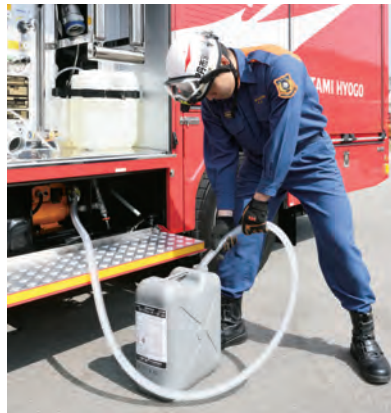
車両左側の燃料タンク横に設置された電動ポンプを使ってポリ容器などの薬液を車両薬液タンクに送液することが可能となっている。
