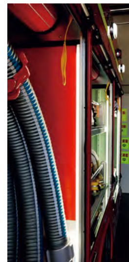
ポンプ室から積載庫の柱にはテープ式のLEDライトを配置し、夜間活動の照度を高めることで、隊員の安全な活動に寄与している。
