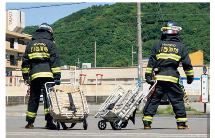
ホースキャリアを2台積載。50mmホースを3本収容可能で軽量かつコンパクトなホース延長資機材。
