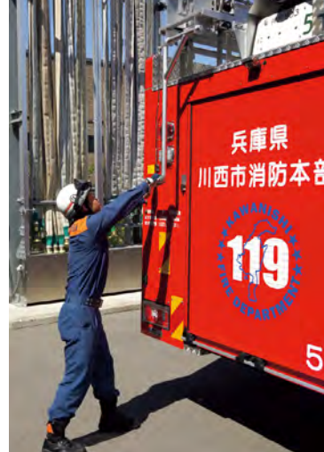
ポンプ操作盤には外部吸液口が設けられ、専用ホースを接続することで薬液ポリタンクからポンププロポーションナーで吸液できる。
