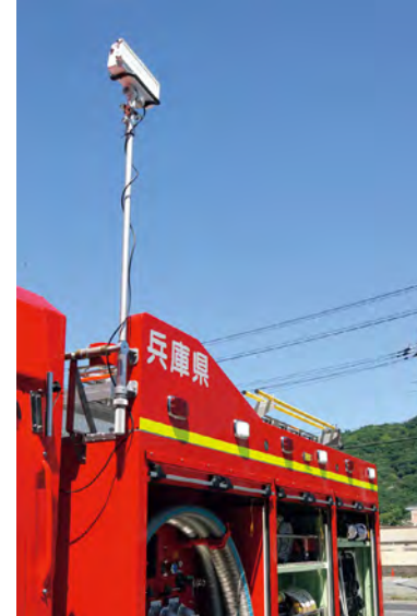
ポンプ室前方には手動昇降式のLED照明装置。
