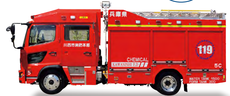
車体側面上部に補助警光灯と作業灯を配置。後方下部には積載水量を示す「WATER TANK 1500」と泡消火薬剤容量「FORM TANK 300」と表記している。
