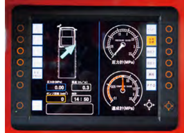
液晶モニターには車上部に設置された風速計で測定した風速を表示できる。
