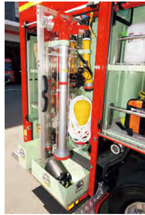
パンチング展開扉の内側には、投光器の三脚、ロープが収納されている。
