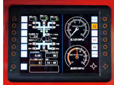
12インチのカラー液晶モニターによる自動揚水システムおよび自動混合操作パネル。アンサーバック方式で操作は容易となっている。
