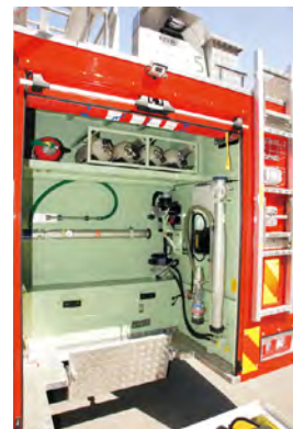
キャブとポンプ室の間に、消火栓開閉金具と川西式トライアングルキーを配置している。
