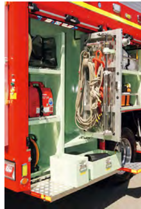
パンチング展開扉の幅はステップ展開時と同等の張り出しとしている。
