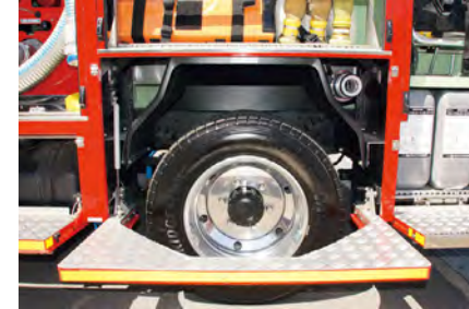
リアタイヤハウスのステップの面積を広く取るため、フェンダー加工が施されている。
