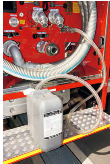
ポンプ操作盤には外部吸液口が設けられ、専用ホースを接続することで薬液ポリタンクからポンププロポーションナーで吸液できる。
