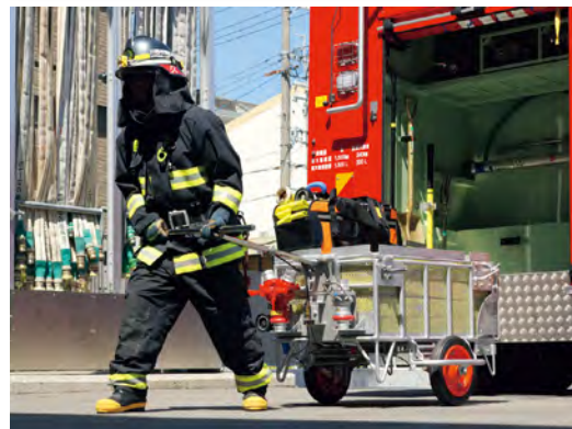
手引きホースカーはアルミ加納式。上面に枠を取り付け、ホース延長時に資機材の落下防止を図っている。
