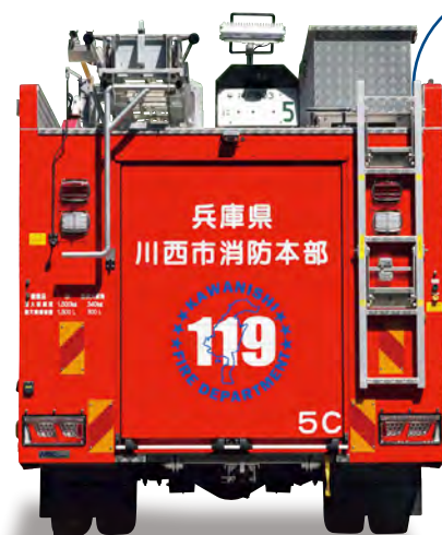
リア上部にLED投光器を設置。シャッターには川西市消防本部のロゴが表記されている。
