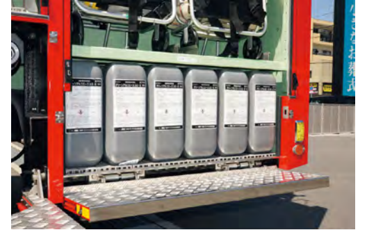
後方の資機材棚下段には車上部に上がらずに活動できるように、外部吸液用泡消火薬剤「グリーンアルコエース 3-3・6」の20リットルポリタンク6本を積載している。
