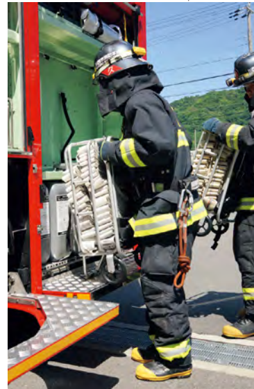
ホースキャリアの取り出しを容易にするため、棚の高さとステップを利用した取り出しに考慮している。
