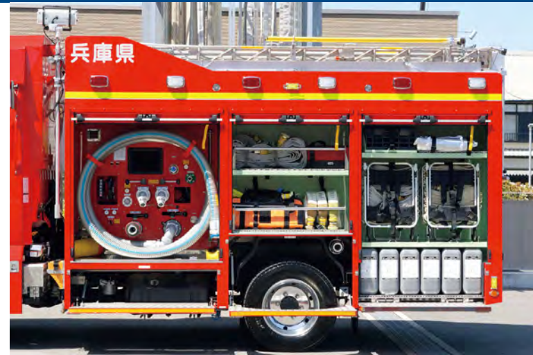
車体側面上部に補助警光灯と作業灯を配置。後方下部には積載水量を示す「WATER TANK 1500」と泡消火薬剤容量「FORM TANK 300」と表記している。
