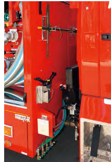
キャブとポンプ室の間に、消火栓開閉金具と川西式トライアングルキーを配置している。
