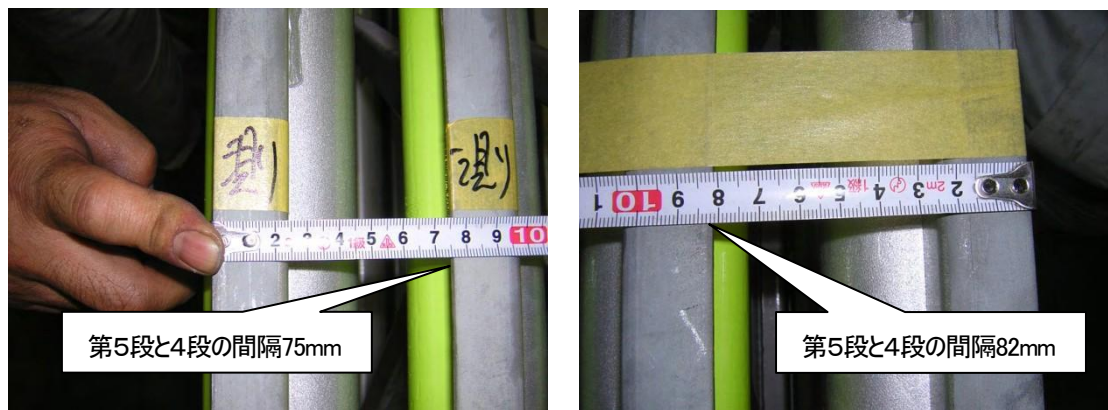
写真6 梯体昇降機用レール
