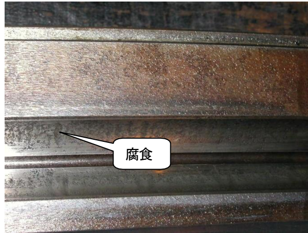
写真9 ターンテーブルボール軌道面
