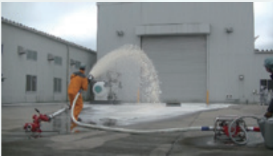
FireDos混合システムによる泡放射
