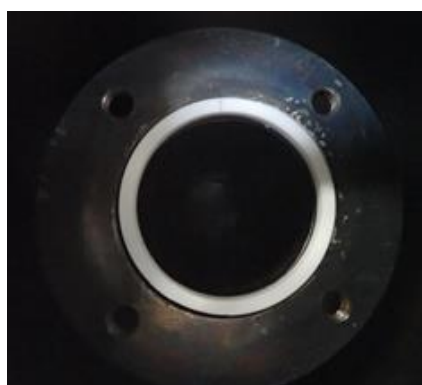
図 1 1. パッキン装着の様子
