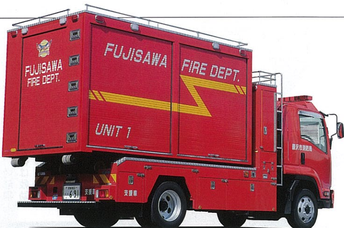
箱形ユニットを搭載した状況。広域応援時はユニット2に積み替えるだけで即応可能。
