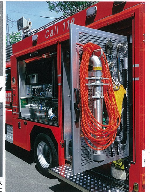
左側面のシャッター内。車体前方(画面左側)がポンプ装置操作盤と収納スペース、後方が資機材収納スペース。ポンプ装置操作盤は右側では少量泡混合装置の接続パイプだった部分が吸水口になっている。 [左側面]
