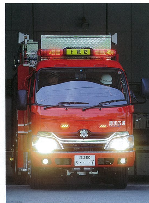
トヨタダイナの3トン級シャーシをベースとしている。
