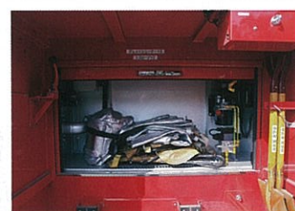
ホースレイヤー収納部の奥の収納庫には、耐熱服一式を収納している。
