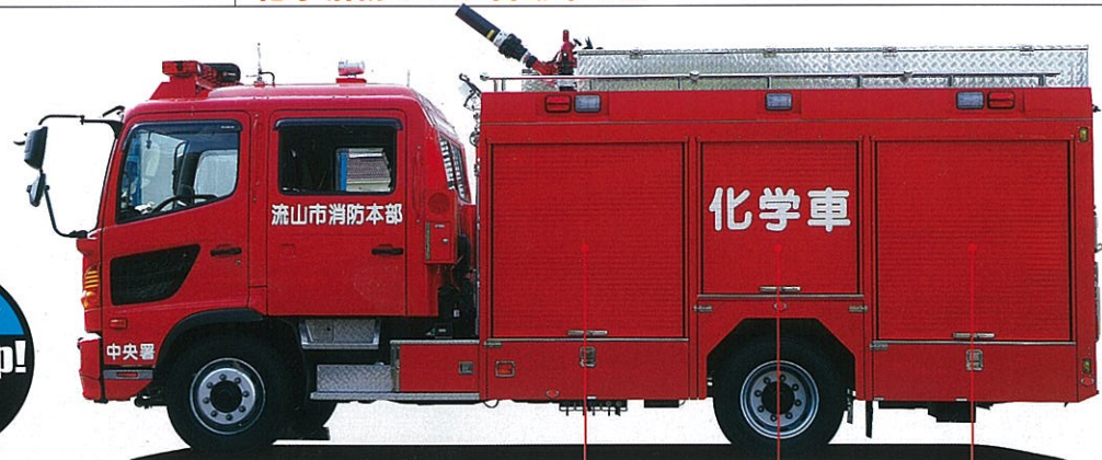
[左側面] 車両左側面。撮影のために放水銃にノズルを装着している。
