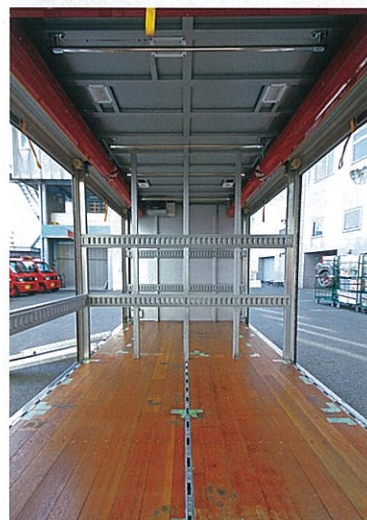
カートの固定を行うラッシングレールは着脱が可能。
