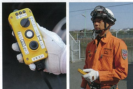
有線式リモコンは車内に用意されており、機関員が降車時に携行して車外で操作できる。ケーブル長に関わらず任意の場所操作が行えるワイヤレスリモコン。
