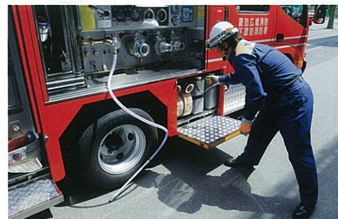
右側面のシャッター内は、前方(画面右側)がポンプ装置の操作盤と資機材収納スペース、後方が資機材収納スペースとなる。後部のホースカー収納スペースを避けている後方資機材収納スペースの前側は左右貫通構造で、資機材を収納ボックスに入れて収納する。 [右側面]
