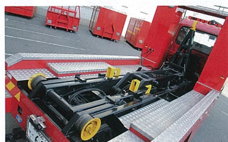
脱着ポディーギミックには極東開発工業製のフックロールJM-07-50を採用している。
