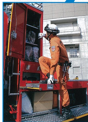
高い位置にある積載棚へアクセスするため、引き出し式ステップを装備。
