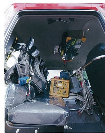
天井中央部に小物などが収納できる収納棚を取り付けている。後部シートには4基の空気呼吸器を装備。中央付近に折り畳み可能なテーブル兼書類入れを取り付けている。
