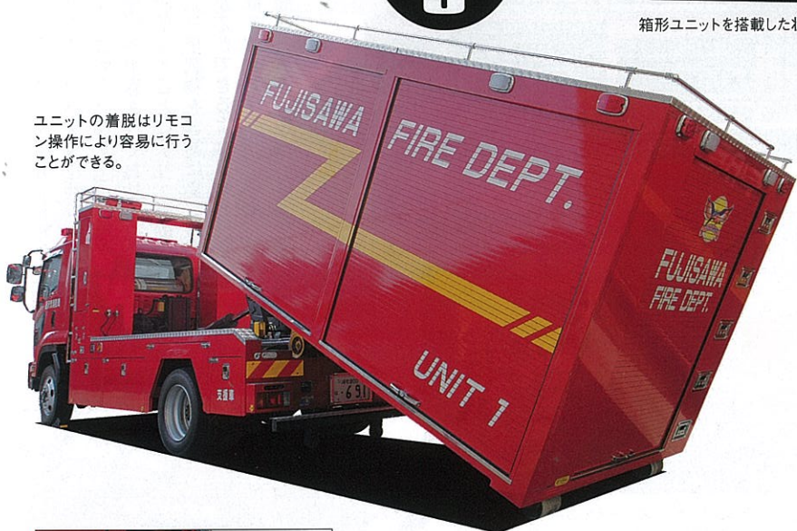
有線式リモコンは車内に用意されており、機関員が降車時に携行して車外で操作できる。ケーブル長に関わらず任意の場所操作が行えるワイヤレスリモコン。
