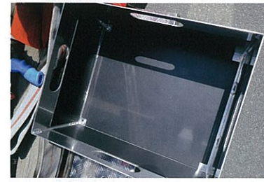
左側面のシャッター内。車体前方(画面左側)がポンプ装置操作盤と収納スペース、後方が資機材収納スペース。ポンプ装置操作盤は右側では少量泡混合装置の接続パイプだった部分が吸水口になっている。 [左側面]
