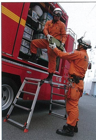
ユニットを降ろさずに積載物を出し入れできるよう、専用踏み台も用意されている。
