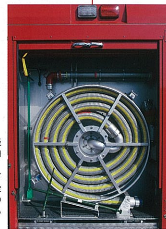
左後方に電動吸管巻取装置(口径75mm×10m)を配置、スタンドパイプや消火栓開閉器具などの最小限の機材も収納できる。
