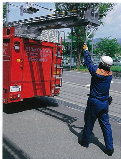
後面にはシャッター内にホースカーが収納されている。その上にホースなどを収納可能なラックが設けられている。 [後部]
