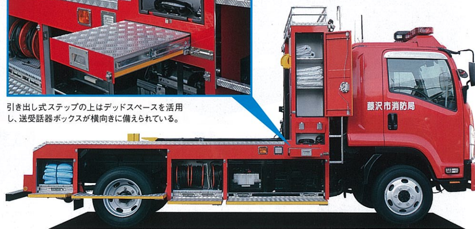
積載庫は左右ほぼ同等のレイアウト。現場で多用するブルーシートなどを収納している。
