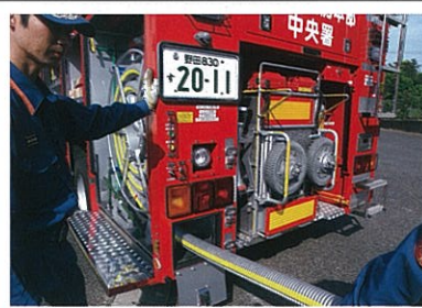
吸管の引き出しはスムーズで迅速な消火活動に寄与する。巻き取りはボタン操作で簡単にできる。
