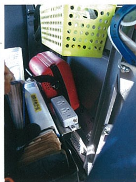
車両内にインバーターを取り付け、収納スペース後部にコンセント2口を設け、無線機や携帯電話の充電が可能である。
