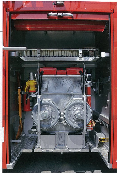
後面にはシャッター内にホースカーが収納されている。その上にホースなどを収納可能なラックが設けられている。 [後部]
