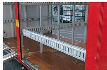
カートの固定を行うラッシングレールは着脱が可能。
