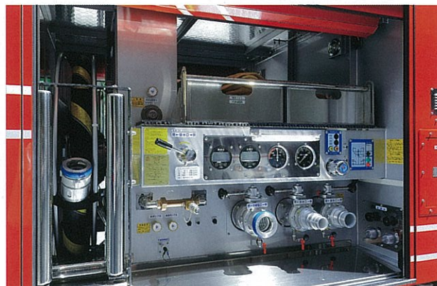
右側面のシャッター内は、前方(画面右側)がポンプ装置の操作盤と資機材収納スペース、後方が資機材収納スペースとなる。後部のホースカー収納スペースを避けている後方資機材収納スペースの前側は左右貫通構造で、資機材を収納ボックスに入れて収納する。 [右側面]
