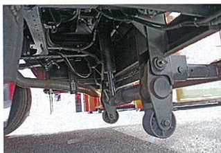
ユニット着脱時に使用するジャッキは、支援車Ⅱ型としては初となる油圧自動展開式を採用。
