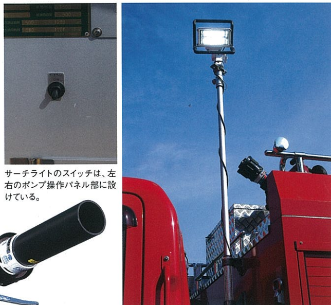
サーチライトは手動で伸縮、回転、俯仰可能なポールタイプのウィレン製スーパーLEDサーチライトをキャブ後方に取り付けている。
