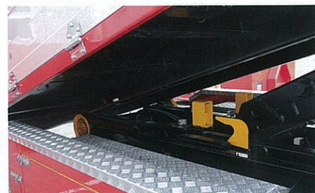
写真右寄りの黄色い爪で、各種ユニットをがっちり確保する。
