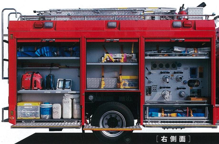
車両右側面のシャッターを開放した状態。後方収納庫には予備ホース、照明器具(発電機、投光器、三脚、コードリールなど)、水筒、塩化カルシウムなどの資機材を収納。中央の収納庫には予備ホースや吸管ちりよけなどの細かい資機材を、前方シャッター部分にはポンプ操作部を配置。上下の空きスペースにホースやノズルなどを収納する。下部の収納ボックスには口径65mm消防ホース3本以上を管巻を付属した状態で収容できる。
