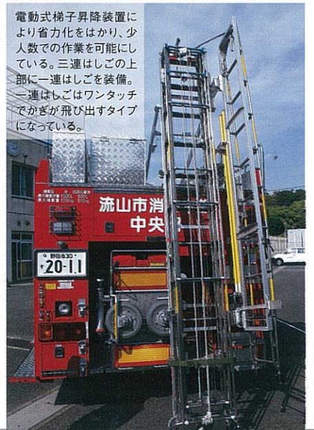
油圧昇降装置付きのホースカーは車輪が折り畳み式。ルーフに電動式はしご昇降装置付きの三連はしご一連はしごを装備することで、汎用性を高めた仕様になっている。
