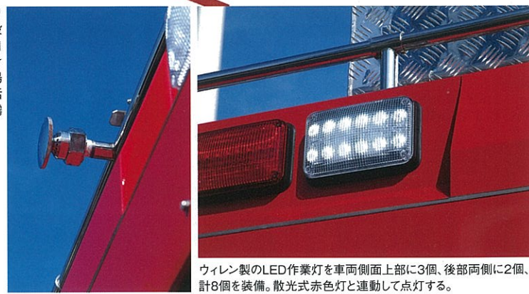
サーチライトは手動で伸縮、回転、俯仰可能なポールタイプのウィレン製スーパーLEDサーチライトをキャブ後方に取り付けている。
