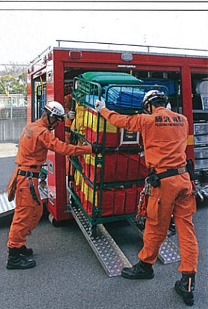
スロープはコンテナサイズに合わせて間隔を調整できるよう2本1組の構造としている。ユニットの剛性を確保するため、中央部分には補強の間仕切りが備えられている。
