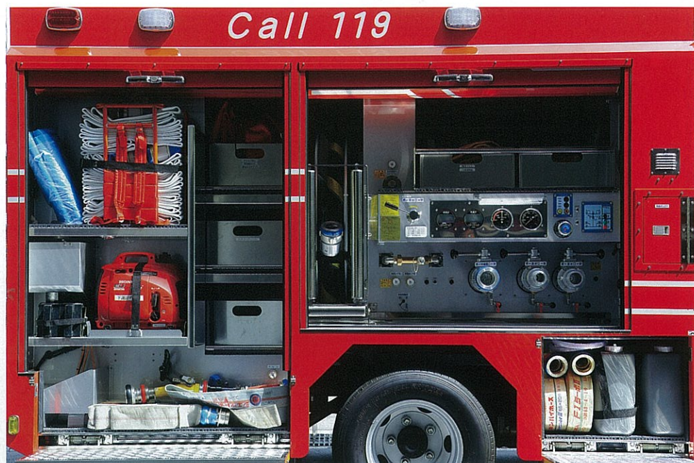
右側面のシャッター内は、前方(画面右側)がポンプ装置の操作盤と資機材収納スペース、後方が資機材収納スペースとなる。後部のホースカー収納スペースを避けている後方資機材収納スペースの前側は左右貫通構造で、資機材を収納ボックスに入れて収納する。 [右側面]
