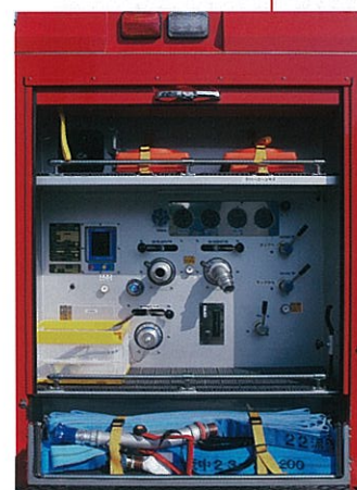
左側面前方シャッター部分には、ポンプ操作部を配置。上下の空きスペースに折り畳み式コーンとホースを収納する。下部の収納ボックスはワンタッチスライド式を採用する。
