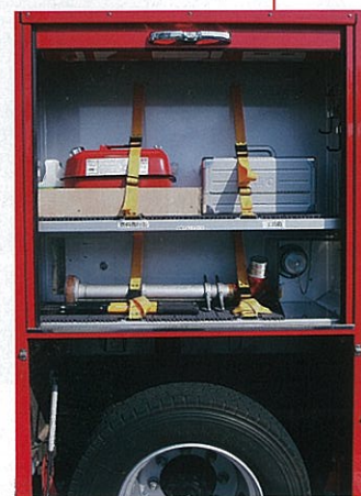
中央の収納庫には燃料携行缶や工具類、スタンドパイプなどを収納する。
