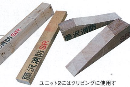
ユニット2にはクリッピングに使用するクリップ材約70本を積載。
