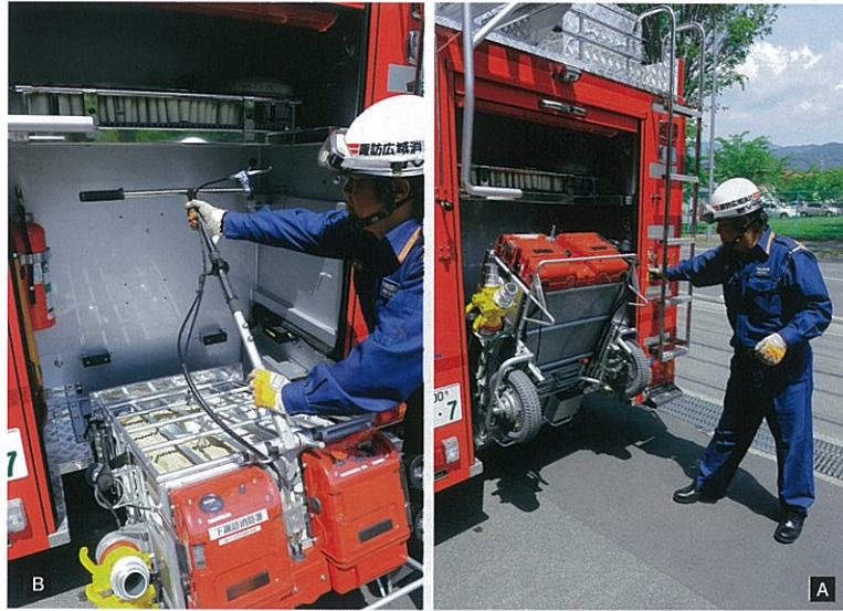
▲Bホースカーは昇降装置によって車体から降ろされる。その際、ホース積載棚とハンドルが干渉しないよう欠き込みしている。
