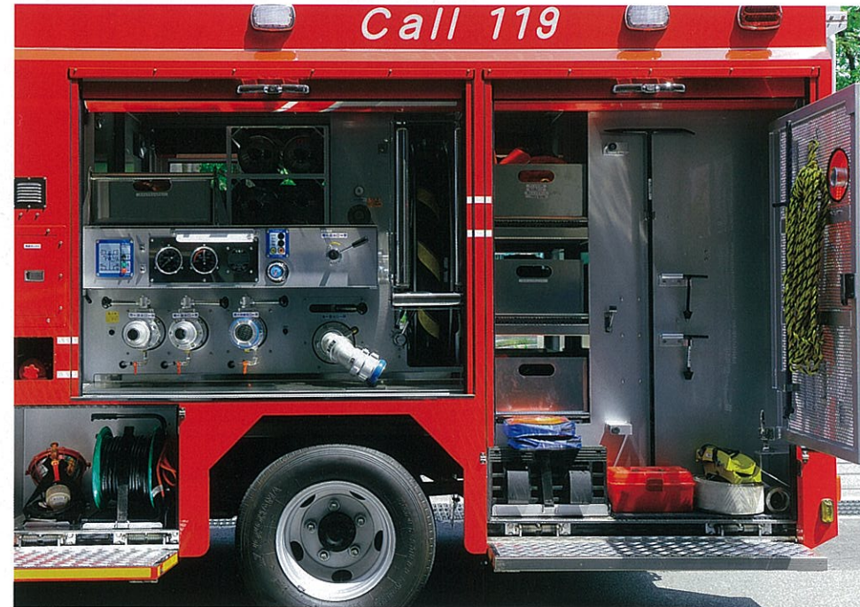
左側面のシャッター内。車体前方(画面左側)がポンプ装置操作盤と収納スペース、後方が資機材収納スペース。ポンプ装置操作盤は右側では少量泡混合装置の接続パイプだった部分が吸水口になっている。 [左側面]
