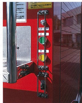
はしご昇降装置の操作ボタンは右側に配置、ボタン操作で上昇/下降を行う。
