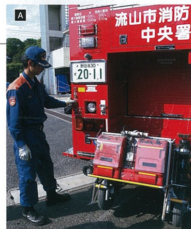
▲ホースカーの油圧昇降装置の操作ボタンは左側に配置されている。 ■電動アシスト付加納式のホースカーは、本体重量が約90kg。最高速度9km/hで約30分程度の連続走行が可能になっている。
