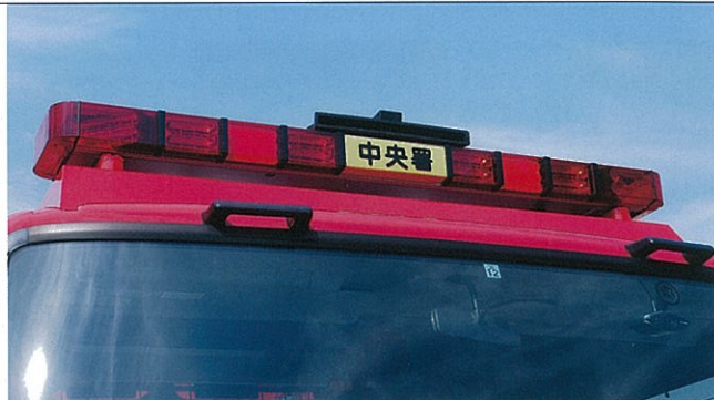
赤色警告灯 ウィレン製の1520mmスピーカー内蔵の赤色散光式警告灯をルーフ部に装備。
