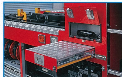
引き出し式ステップの上はデッドスペースを活用し、送受話器ボックスが横向きに備えられている。
