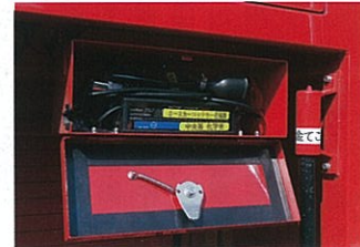
ホースレイヤー専用の充電器。始業点検時に常に充電状態をチェックする。
