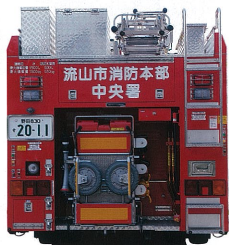
油圧昇降装置付きのホースカーは車輪が折り畳み式。ルーフに電動式はしご昇降装置付きの三連はしご一連はしごを装備することで、汎用性を高めた仕様になっている。
