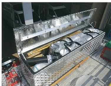
資機材収納庫上の資機材収納ボックス。放水銃用の薬液ノズル、化学防護服などを収納しており、ボックスの左側にはLED式照明灯を設置している。
