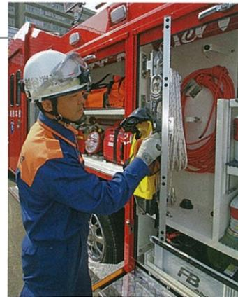
パンチングメタル製の展開パネル部分を開くと、ロープ収納部が見える。
