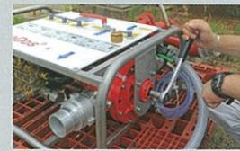
電気的な機構などは一切ないため、メンテナンスも付属のラチェットレンチにて水力モーターをたまたみに回し、固着を防ぐ程度でよい。
