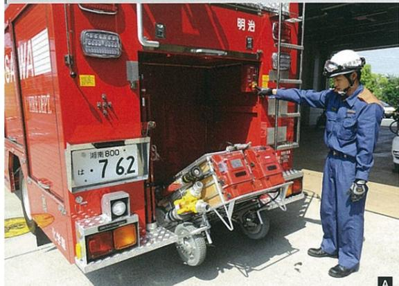
ABC ホースカーは電動アシストによって車両に降積載する。電動アシスト装置はホースカー収納台が90度下方へ展開することによって、ホースカーを地上へと開放する。
