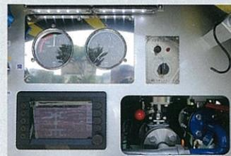
ポンプ装置と薬液混合装置の操作盤。上段左は連成計(左)と圧力計(右)、右は自動比例混合装置の電源投入スイッチと混合比調整ダイヤル(任意の濃度3%/6%)、下段左はポンプ装置の運用画面、右はポンプ室へのアクセス口で、レバーによって混合比を任意に調整できる。
