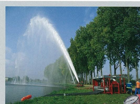
大型のFireDos混合システムと放水砲を組み合わせれば、大容量泡放射システムとして運用することもできる。(写真提供/日本ドライケミカル)
