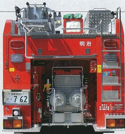
車体後面。リヤオーバーハングの短縮化のため、ホースレイヤーではなく電動アシスト式のホースカーを採用。
