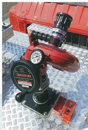
毎分2000リットルの放水が可能なヨネ製クロスファイヤー放水銃。放水方向、高さが調整ができる。放水銃横の小箱内にあるスイッチで電動弁を作動させると放水できる仕組みだ。
