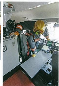
後部への移動などを容易にするため、隊長席も座面跳ね上げ式としている。運転席後ろに見えるのが横向きシート。
