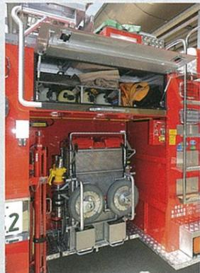
ホースカー収納庫上のデッドスペースは資機材収納スペースとして空気ボンベなどを収納している。ホースカー収納庫内には照明装置のスタンドも収納している。
