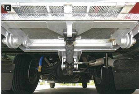
三連はしごと車はしごは手動昇降装置によって資機材収納庫上に収納する。
