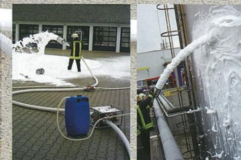
▲可搬式ユニットを用いれば、現場の任意の場所で薬液混合を行うことができる。
