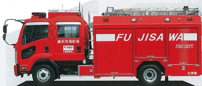
極力小さく製作するためにリアのオーバーハングを短縮し、さらに急坂に対処するため後端を斜めにカットしている。
