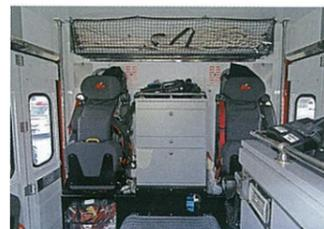
最後部の座席にある折り戸は気窓であるため、座席脇に通風孔を設けている。これにより車内換気を行うことができる。
