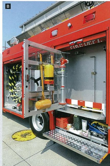
▲左側面のポンプ装置操作盤と資機材収納庫。後部ラックは展開式で、後部資機材収納庫の下辺が急坂対策のため後輪前部よりやや高くなっていることがわかる。
