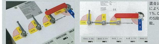
混合比率をセットした状況。0.3%と0.7%のレバーを入れているため、設定混合比率は1.0%となる。
