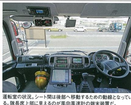
運転室の状況。シート間は後部へ移動するための動線となっている。隊長席上部に見えるのが風向風速計の端末装置だ。
