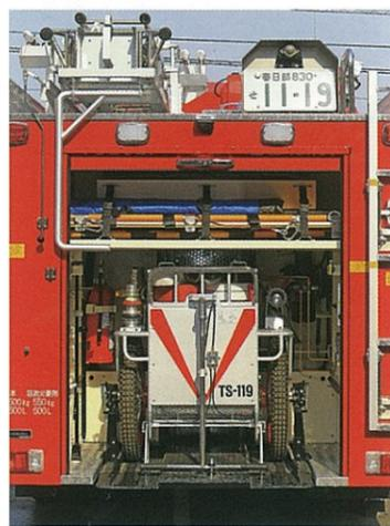
後部にはホースカーが収納されていて、その上部には左右貫通式の救助用平担架収納スペースがある。
