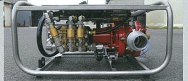
右側の吐水口を備えた部分が水力モーター。これにより左側の混合ポンプを動作させる。
