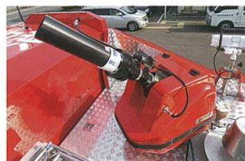
放水銃はYONEのマルチロボモニタを採用した。先端にアタッチメントをセットすることで泡放射に対応する。
