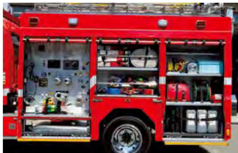
左側面も基本構造は右側面と同じ。後部収納部には発動発電機や投光器等を収納する。
