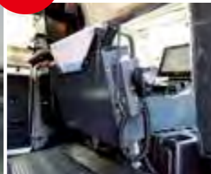
後部座席右側には、広報用マイクとモーターサイレンスイッチを設置。隊長は無線等による情報収集が多忙のため、同署では右後部隊員(簡先隊員)が緊急走行時の注意喚起を行う。
