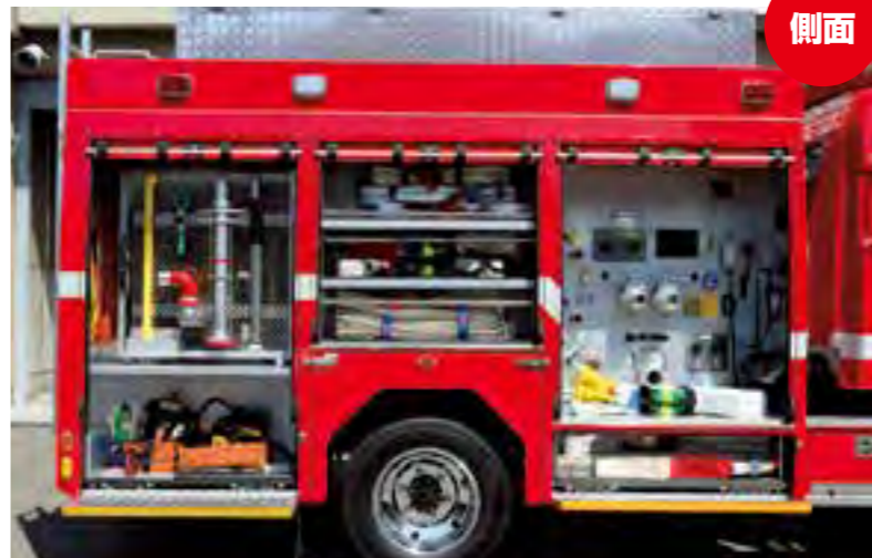
右側面。収納力を確保するためポンプ操作室はなるべくコンパクトに製作した。火点に直近部署する先着車両であるため自己吸水は基本的に行わない。
