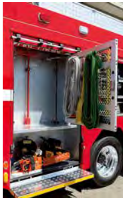
右側後部は展開式収納扉とし、ロープ類や地下式消火栓器具等を収納。チェーンソーやエンジンカッターは鉄のドアや土蔵の扉等を破壊するのに便利。
