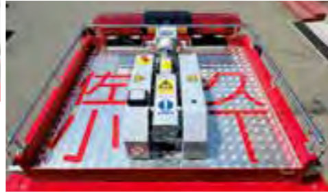
キャブ上の作業台には日本初導入となるテークライトを設置。コンパクトなのではしごの車上伸梯の際の邪魔にもならない。左上には緊急停止ボタンも備える。
