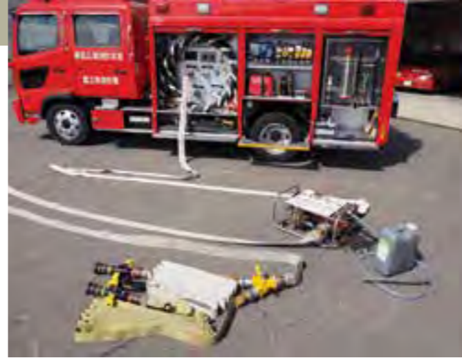
ファイアドス装着例。双管で2基のガンタイプノズルに分岐させている。
