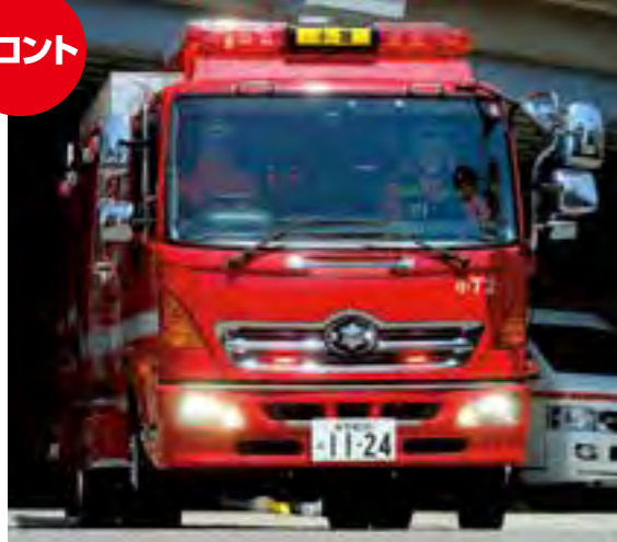
キャブはハイルーフ化せず、鍍銀作業台のみ設置。LEDは日照角度によっては見えにくいので、ハイブリッドタイプの警告灯を採用した。
