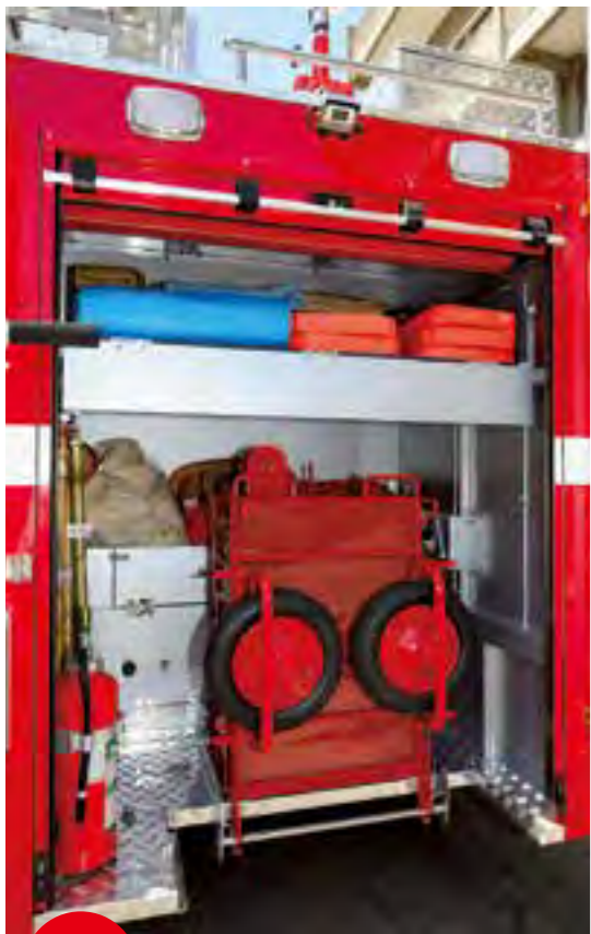
特注の薄型ホースカー。65mmホースを7本搭載する。
