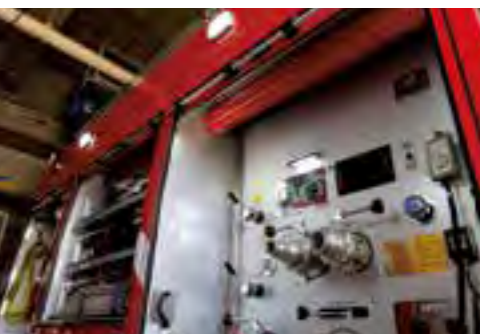
スモールランプを点灯すると、シャッター内の照明はすべて自動で点灯する。これも省力化のための工夫だ。
