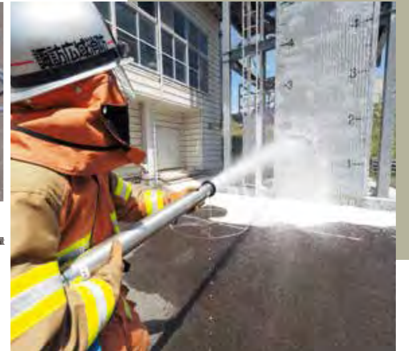
ファイアドス装着例。従来型の泡管鎗を取り付ければ、長距離の泡発砲も可能。
