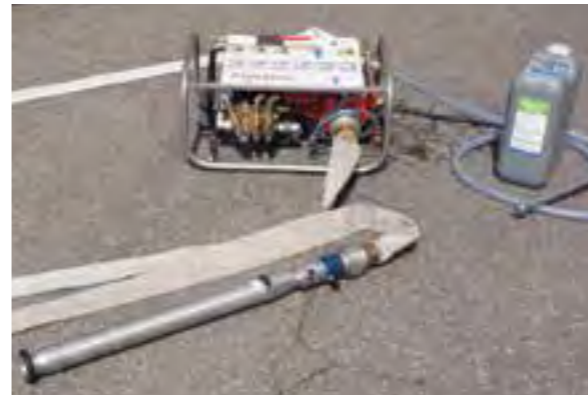
ファイアドス装着例。従来型の泡管鎗を取り付ければ、長距離の泡発砲も可能。
