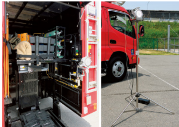
ホースカーとともに降下した資機材収納棚。向かって右側には佐藤工業所製「ソブライトII」LED式照明装置(容量60W)が設置され、付近に設けられた交流100V出力から電源が供給される。照明装置は取り外し可能で、電源さえあれば専用スタンドによりどこでも持ち運び可能。超軽量のため隊員の腰部にも取り付けられる。
