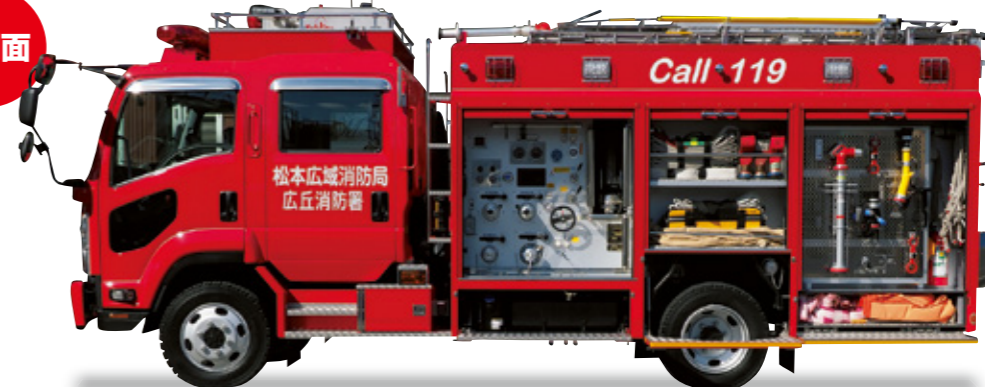
オールシャッター化した収納庫。前方からポンプ部、ホース収納部、展開式扉収納の資機材収納部と明確に分類されている。
