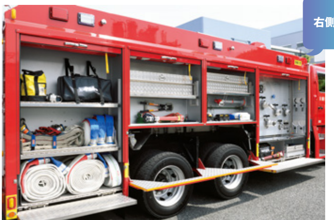
ホース、筒先など積載資機材が多く、積載スペースは水槽、薬液槽に沿って細長く設置されている。
