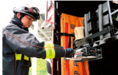
ホースカーには前面に二股金具、媒介金具、逆延長用具、トップマンなど、左右側面に筒先の固定金具が設置され、上面のふた部をパンチングボードにすることにより資機材を積載可能。
