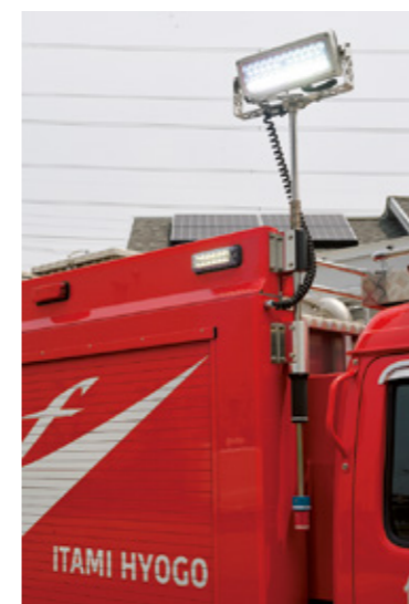
水槽のダブルキャブ側右側にはLED式照明装置(容 量225W)。手動により上昇可能。
