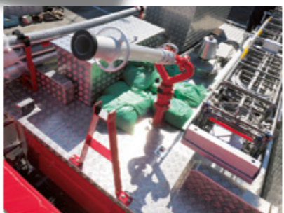
手摺りを有効な場所に取り付け、アクセスのしやすさを実現している。
