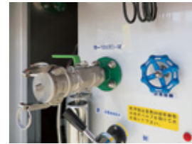
右側には泡消火薬剤を混合するための外部吸液口がある。
