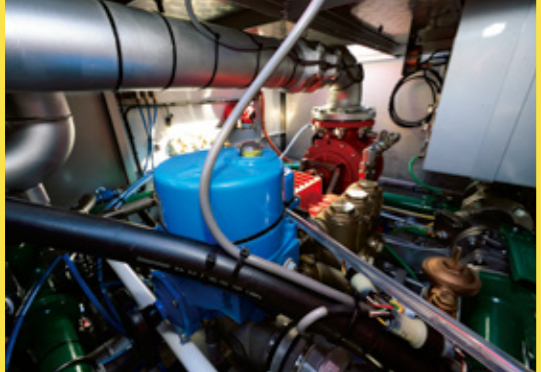
ポンプ室の後方には水槽(写真上)、薬液槽(下)の順番で並ぶ。薬液はクラスBフックたん白泡消火薬剤。
