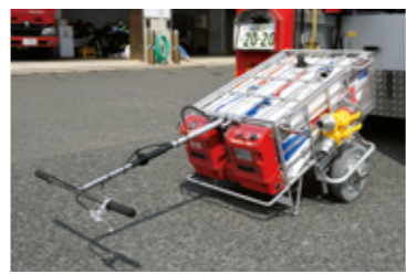
▲ホースカー収納部は奥まで資機材収納スペースとして活用される。
