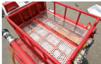
ホースカーには前面に二股金具、媒介金具、逆延長用具、トップマンなど、左右側面に筒先の固定金具が設置され、上面のふた部をパンチングボードにすることにより資機材を積載可能。
