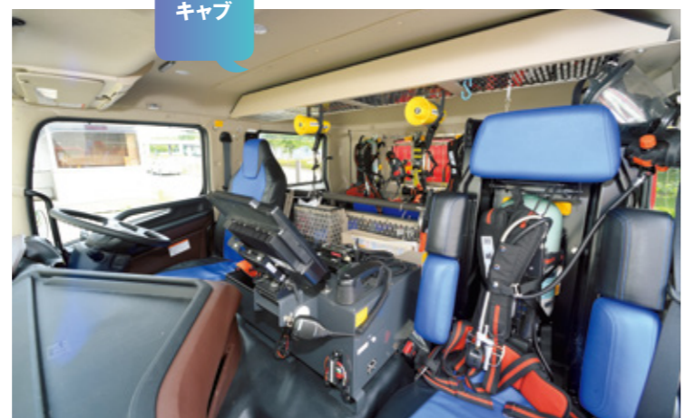
乗車定員6名のダブルキャブ。隊長席と後席後方には空気呼吸器の収納スペースが設けられている。
