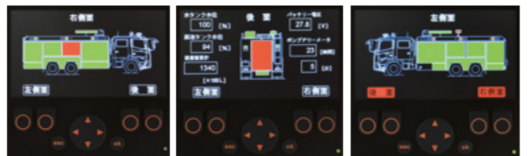
フロントガラスの上部、中央やや左付近には左右側面(屋上泡放射砲を含む)、後面のシャッターや砲の未収納、照明装置未消灯などの警告パネル。
