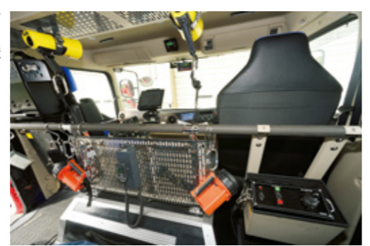
フロントガラスの上部、中央やや左付近には左右側面(屋上泡放射砲を含む)、後面のシャッターや砲の未収納、照明装置未消灯などの警告パネル。
