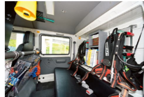
4名乗車を基本とするため、後席中央の背後には空気呼吸器のラックではなく、他署管内の防ぎょ計画書、救急バッグなどが収納されたラックが設置されている。
