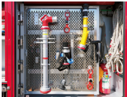
オールシャッター化した収納庫。前方からポンプ部、ホース収納部、展開式扉収納の資機材収納部と明確に分類されている。
