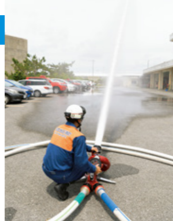
1分間の最大放水量は4500Lあり、威力はかなり期待できる。
