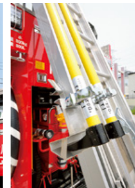
二連はしごの積載ガイド横に積載され た2本のとび口には、日本ドライケミカ ルの織装らしく刃のガードを設置。
