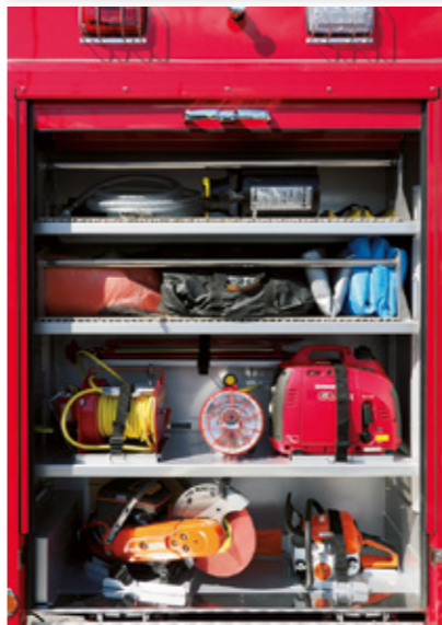
最後部の資機材収納部には発泡筒先や吸上ホース、救命胴衣、水損防止シート、投光器一式、チェーンソー、エンジンカッターなどを搭載。
