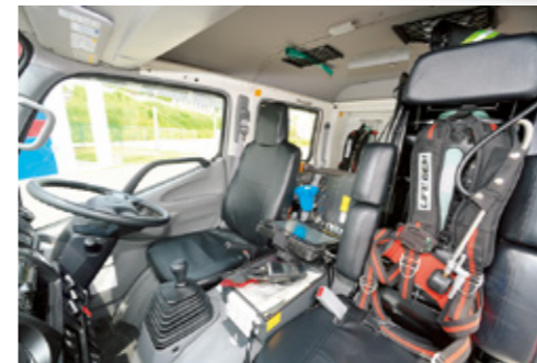
定員5名のダブルキャブ。ミッションはMT5速。隊長席と後席には空気呼吸器の収納スペース。
