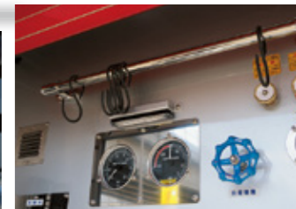
バーとS字フックの設置により、活動終了後の濡れた防火衣をポンプ部に収納できる。
