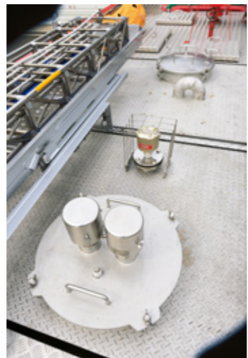
ポンプ室の後方には水槽(写真上)、薬液槽(下)の順番で並ぶ。薬液はクラスBフックたん白泡消火薬剤。
