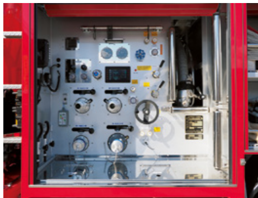
夜間活動時、各レバーの作動状況は点灯するライトでも確認できる。
