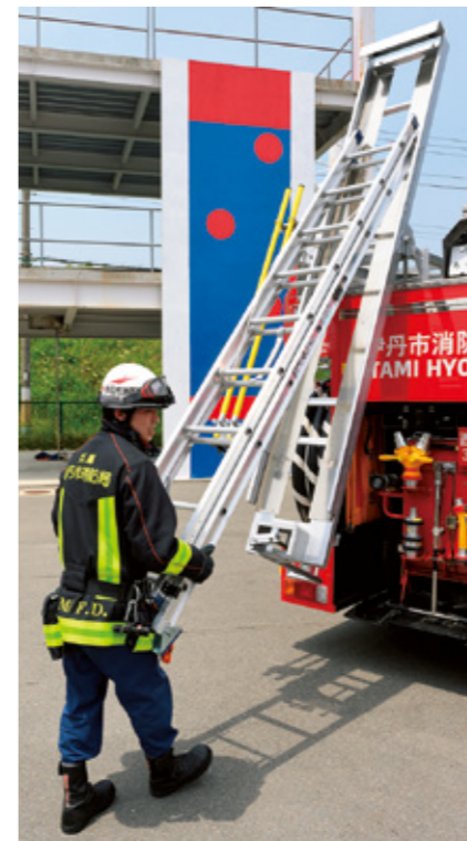
二連はしごの積載ガイド横に積載され た2本のとび口には、日本ドライケミカ ルの織装らしく刃のガードを設置。
