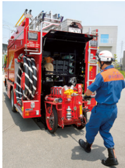
ホースカーの展開と収納は油圧によるパワーゲートによる。その際、上部の収納棚もホースカーと一緒に降下するシステムになっている。
