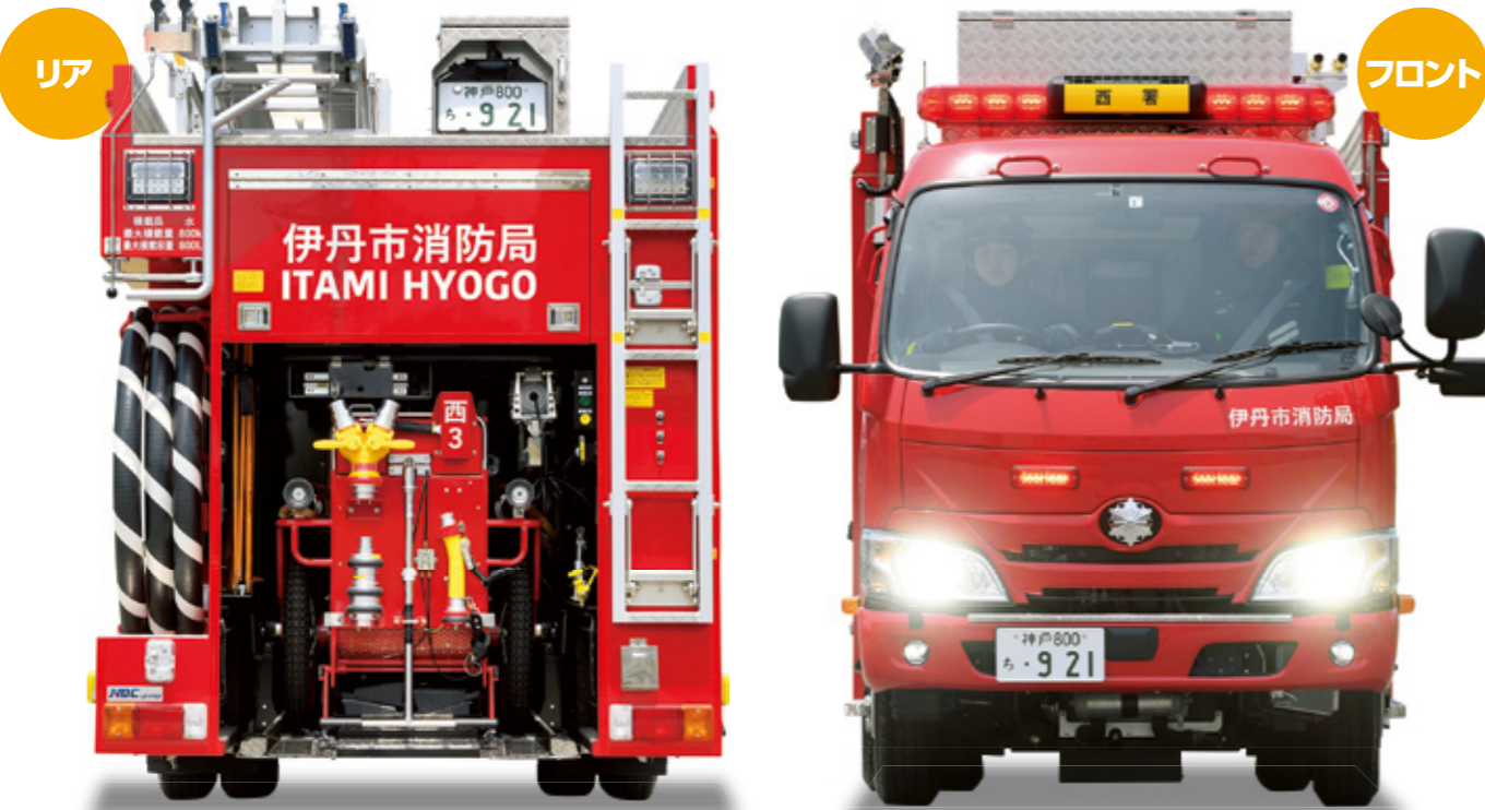
車体後面。左側は巻き取り吸管的の収納性を考え、後部からも収納面が露出する。
