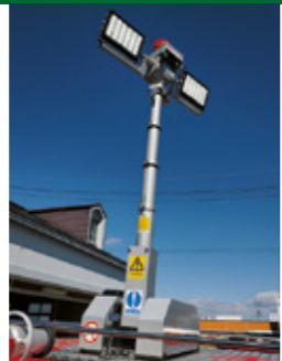
ルーフステージには、バッテリー駆動式の伸縮式LED式投光器「テクライト」を搭載。
