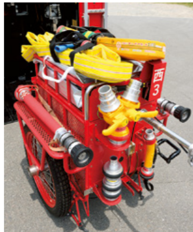
ホースカーには前面に二股金具、媒介金具、逆延長用具、トップマンなど、左右側面に筒先の固定金具が設置され、上面のふた部をパンチングボードにすることにより資機材を積載可能。
