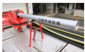
屋上の大容量泡放射砲。1分間当たり放射量は最大3100L。リモコンで操作可能。
