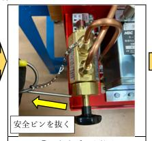
② 安全ピンを抜く レバー側に差した安全ピンを抜 きます。
