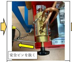
② 安全ピンを抜く レバー側に差した安全ピンを抜きます。
