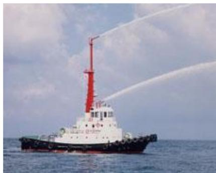
自船消火設備として機関室や貨物艙には二酸化炭素消火設備、ガス運搬船甲板部には粉末消火設備、他船消火設備としてタグボートや消防艇には泡水消火設備や粉末消火設備などがある。対象船舶は大型タンカー、旅客船・フェリー、消防艇など多岐にわたる。
