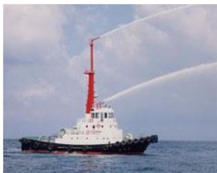
自船消火設備として機関室や貨物倉には二酸化炭素消火設備、ガス運搬船甲板部には粉末消火設備、他船消火設備としてタグボートや消防艇には泡水消火設備や粉末消火設備などがある。
