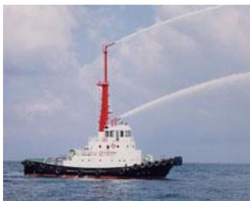
自船消火設備として機関室や貨物艙には二酸化炭素消火設備、ガス運搬船甲板部には粉末消火設備、他船消火設備としてタグボートや消防艇には泡水消火設備や粉末消火設備などがある。
