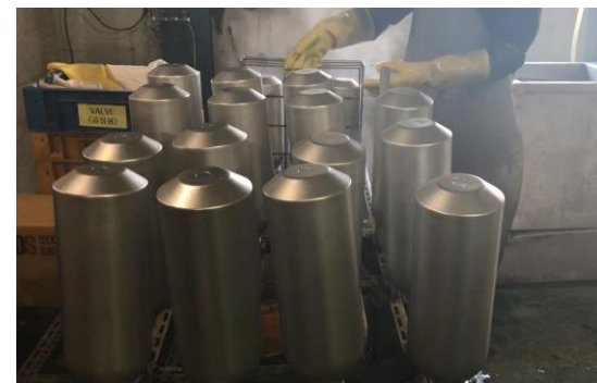
仕上げの洗浄
