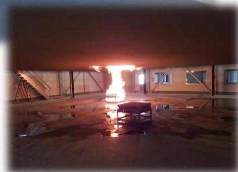
可動式昇降天井による消火実験
