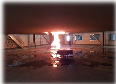
可動式昇降天井による消火実験
