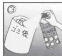
ビニール袋内に「スーパールームガード(Ⅳ)」本体上部ボタンを押して、消火薬剤は水状の物ですので、新聞紙に吸い取らせながら、圧力が完全に抜けるまで、中身の消火剤を放出してください。(放出時間は約31秒。消火薬剤は400グラム入っております)
