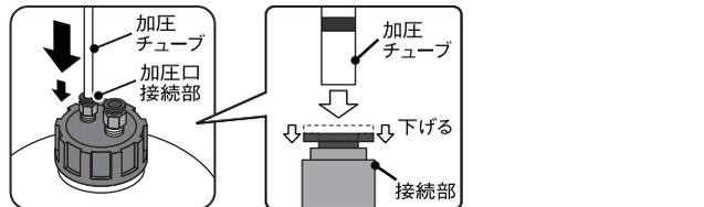
**注意** 3本の加圧チューブのうち、一番左側の加圧チューブは窒素ガス容器の後ろを通すと差し込みやすくなります。(右図参照)
