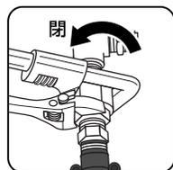
13・封板取付金具をチューブ連結金具にエルボと平行になるように締め付けてください。
