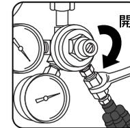
[3] 接続部分に、付属のキャップを取り付けた後、窒素ガス容器のハンドルを左「開」に回し、圧力調整器の一次側及び二次側の圧力を測定します。
