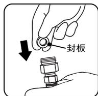
※封板はフィルムがはみだしている方(継目がある面)が上です。
