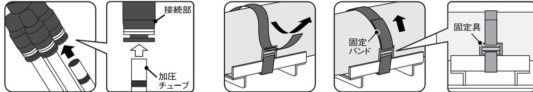
6・先に加圧チューブを加圧口接続部に、きっちりと差し込んでください。(その際、必ずチューブエンド【※1・P12参照】まで差し込んでください。)
