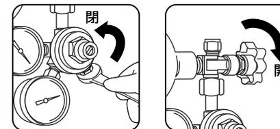
[4] ハンドルを右「閉」に回して閉じます。ハンドルを閉じた後に、二次側の圧力計の針が下がっていく場合には接続部等に漏れがあります。締め直しを行ってください。
