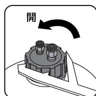
10・チューブ連結金具の封板取付金具をはずし、Oリング2個及び封板を取り出してください。(Oリング・封板、Oリングの順です)
