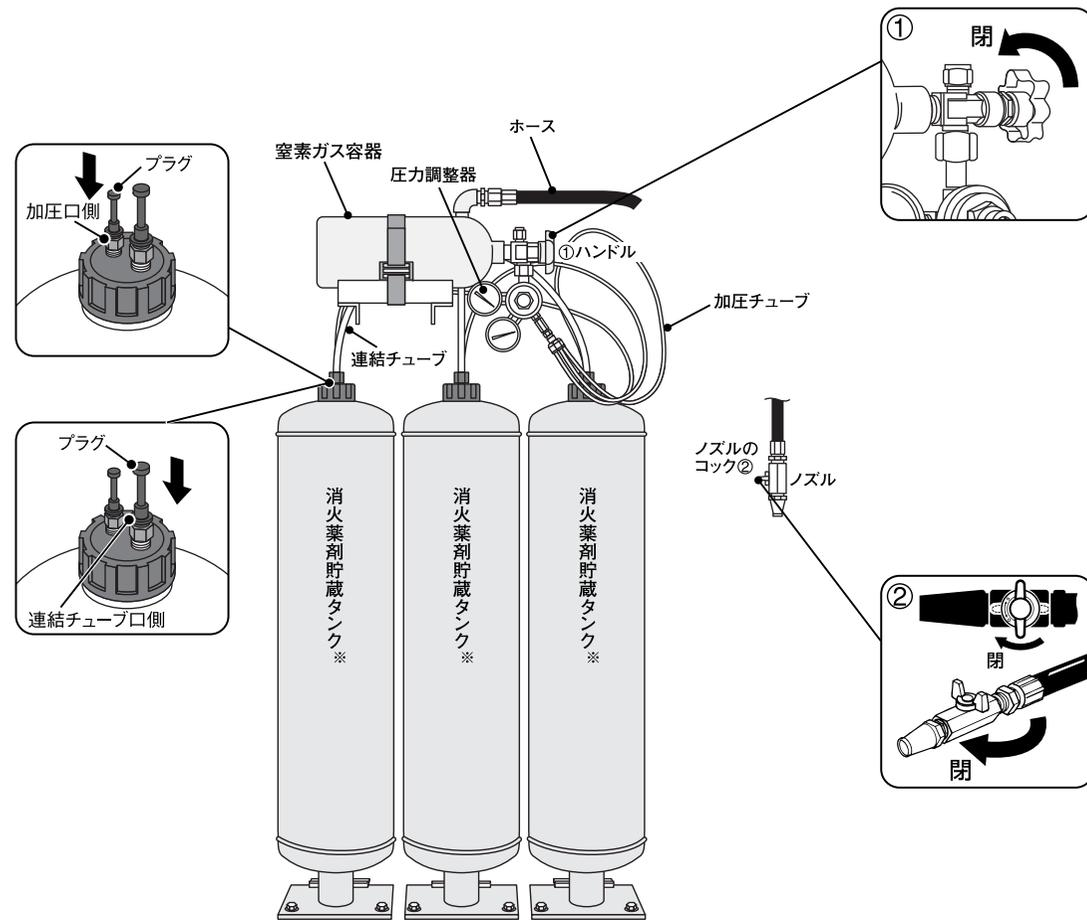
※設置後に格納箱から容器を取り外す場合は、消火薬剤がこぼれる恐れがありますので、必ず加圧チューブを取り外してから、連結チューブを取り外し、共にプラグを取り付けてください。
