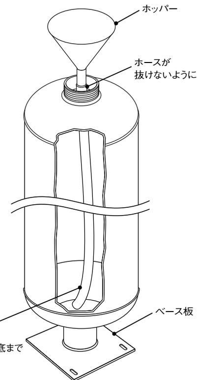
3・消火薬剤貯蔵タンクのベース板の穴に格納箱のボルト穴を合わせて、ボルトを完全に締め、ベース板を固定してください。(中央に消火薬剤貯蔵タンクを固定後、右側・左側タンク[順番は逆でも可]を固定してください。)
