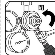
[7] 加圧チューブを圧力調整器の接続部に差し込んでください。(その際、必ずチューブエンド【※1 下記参照】まで差し込んでください。)
