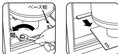
9・消火薬剤貯蔵タンク上部のバルブカバーを外してバルブを取り出し、タンク内の消火薬剤を残らず出してください。
