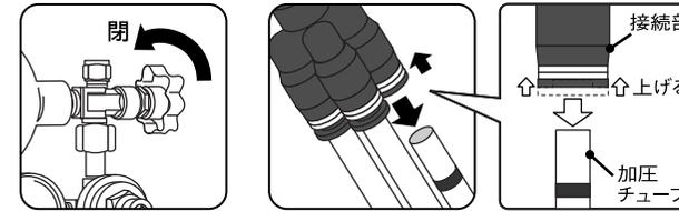
[2] 圧力調整器の接続部を外してください。
