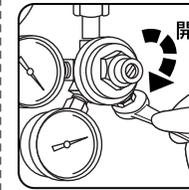
[6] 圧力調整器の一次側及び二次側の圧力が「0」になったことを確認後、キャップを外し圧力調整器の接続部を取り付けます。
