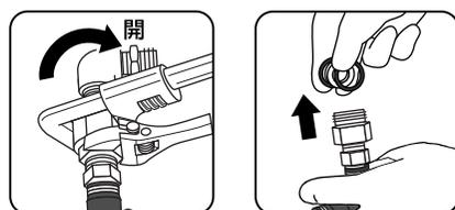
11・消火薬剤貯蔵タンク、バルブ、ホース、ノズル、チューブ連結金具の内面と外面を十分水洗いし、よく乾燥させてください。
