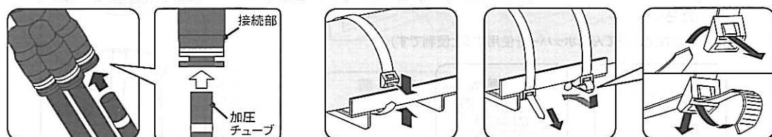
6・先に加圧チューブを加圧口接続金具に、きっちりと差し込んでください。袋ナットを締め付けるときは、加圧チューブを押しながら工具を使って締め付け、手で抜かないか確認してください。【※A図参照】(同じ手順で残り2本の加圧チューブも、加圧口接続金具に取り付けてください。)加圧チューブは【長・中・短】の3種類がありますので、間違わないよう取り付けてください。
