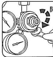
[6] 圧力調整器の一次側及び二次側の圧力が「0」になったことを確認後、キャップを外し圧力調整器の接続部を取り付けます。
