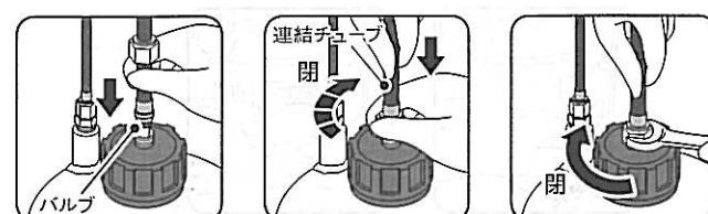
7・次に連結チューブをバルブに、きっちりと差し込んでください。袋ナットを締め付けるときは、連結チューブを押しながら工具を使って締め付け、手で抜けないか確認してください。【※A図参照】(同じ手順で残り2本の連結チューブも、バルブ部分に取り付けてください。)
