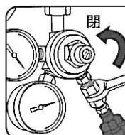
[3] 接続部分に、付属のキャップを取り付けた後、窒素ガス容器のハンドルを左「開」に回し、圧力調整器の一次側及び二次側の圧力を測定します。
