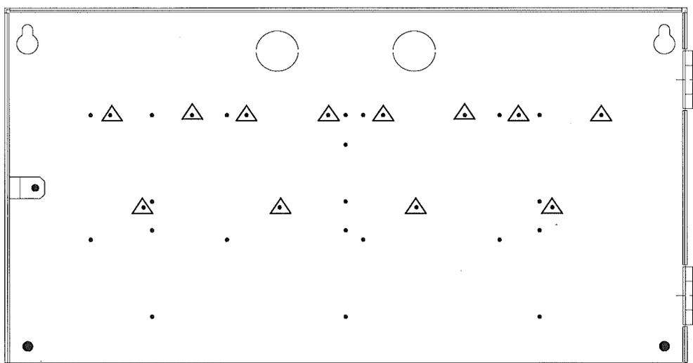
③RX差動式分布型感知器(熱電対式 自動試験対応)の取付孔は、下図の◎印の箇所です。
