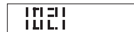
(例4) アルファベット、数字、[-][号][(空白)]を用いて設定した時の火災発報表示
